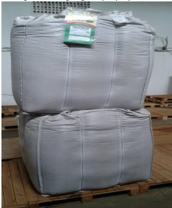
Figura 1: Armazenamento de grãos em big bags de polipropileno com capacidade de 1 tonelada.
