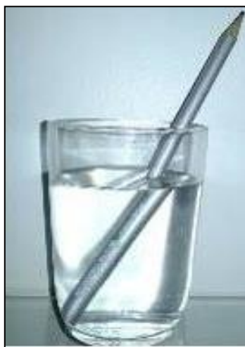
Figura 24 – Experimento simples para explicar a refração da luz.
