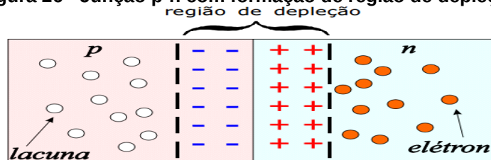
Figura 26 - Junção p-n com formação de região de depleção.
