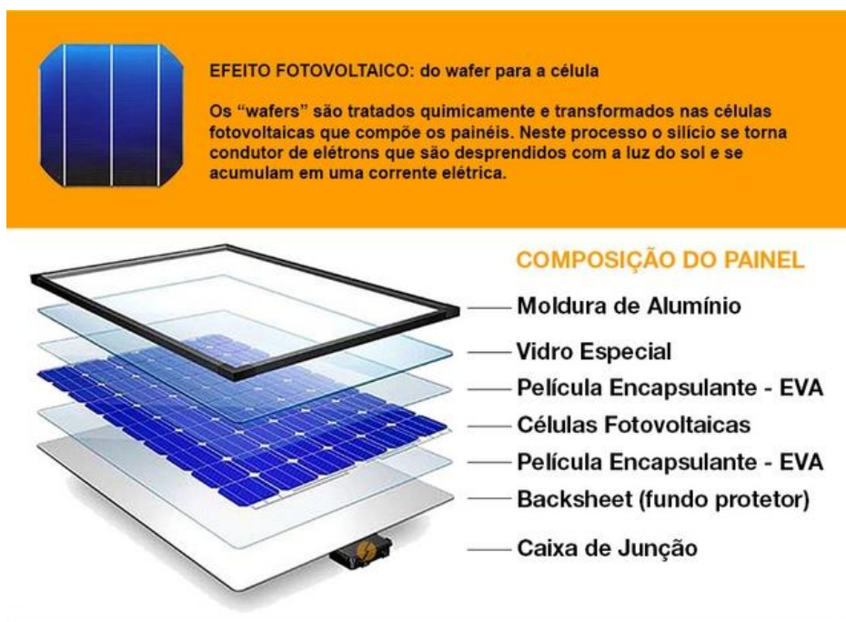
Figura 3 - Visão explodida de um módulo fotovoltaico
