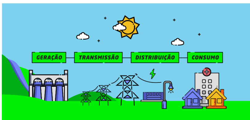
Figura 7 – Geração, transmissão e distribuição da energia elétrica
