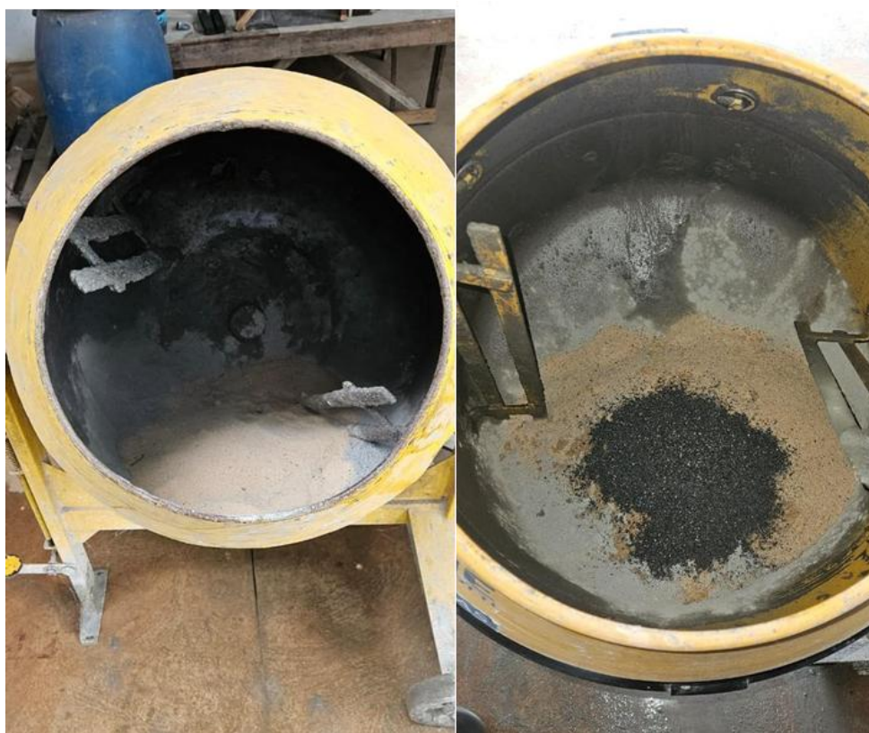
Figura 9 – Junção dos materiais em betoneira
