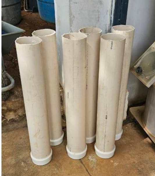
Figura 10 – Estruturas para construção das eletrodos pré-moldados
