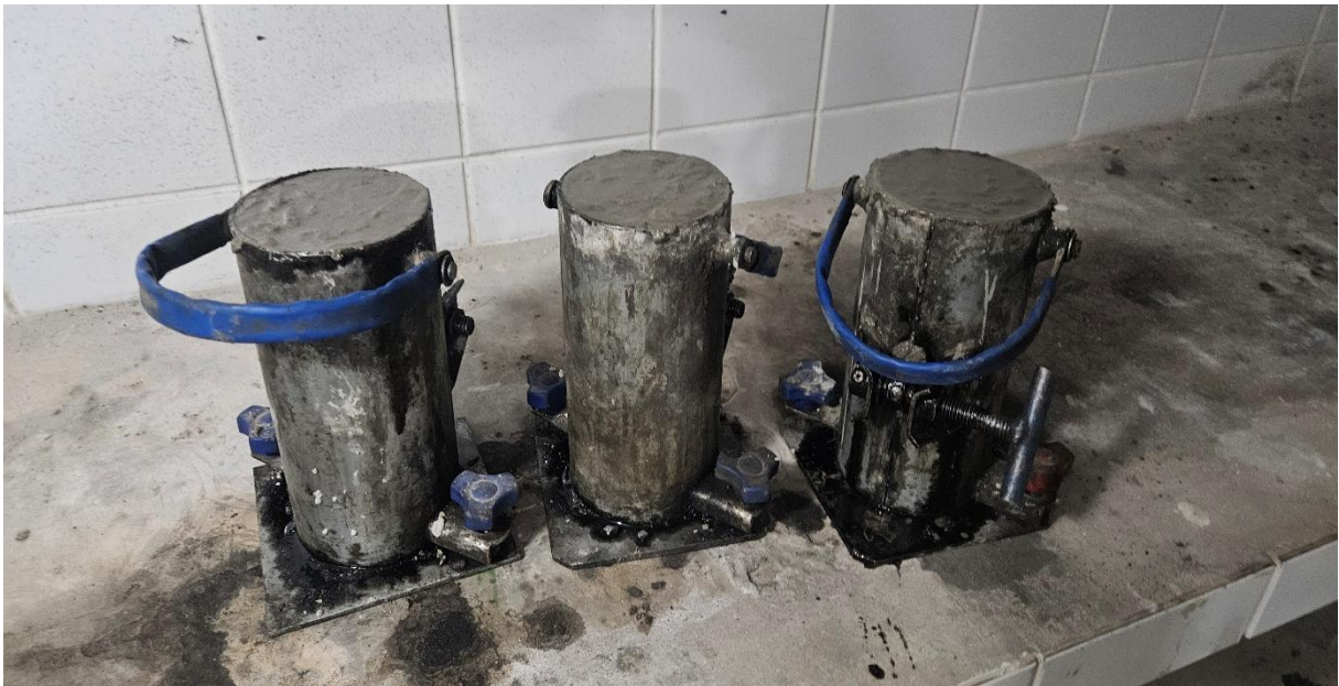
Figura 12 – Corpos de prova para ensaio de compressão
