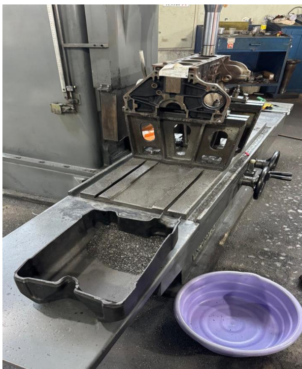
Figura 4 – Coleta do material usinado na retifica Bandeirantes
