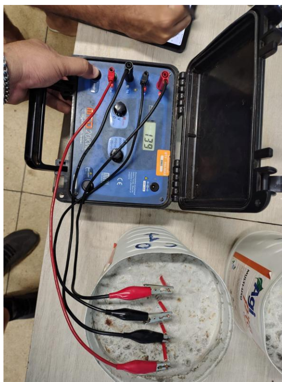
Figura 11 – Ensaio de resistividade realizado no laboratório GESSE
