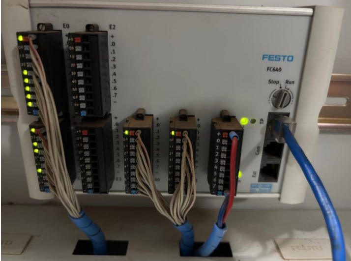
Figura 22 - Bancada Festo FC640 em funcionamento com suas conexões integradas.
