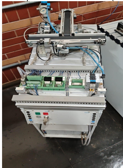
Figura 14 - Bancada eletropneumática Festo F640 (IFTO Campus Palmas).
