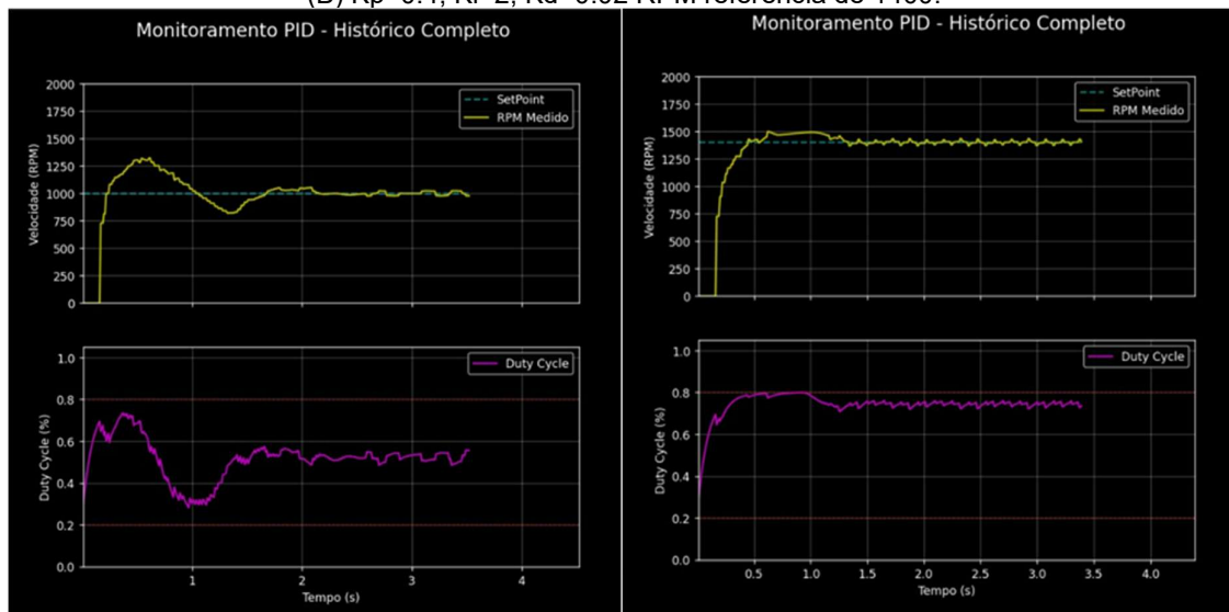
Figura 43: Reposta da malha de controle com: (A) K_p=0.2 , K_i=2 , K_d=0.04 , RPM referência de 1000. (B) K_p=0.4 , K_i=2 , K_d=0.02 RPM referência de 1400.
