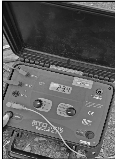
Figura 31 - Resultado no Terrômetro a distância de 24 metros
