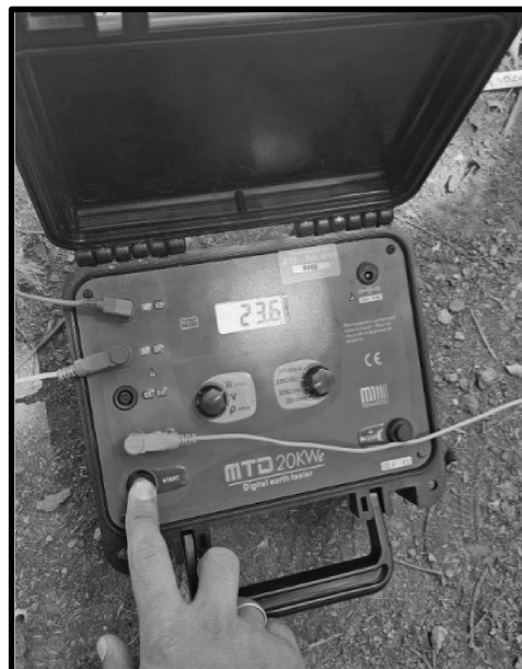
Figura 32 - Resultado no Terrômetro a distância de 24 metros
