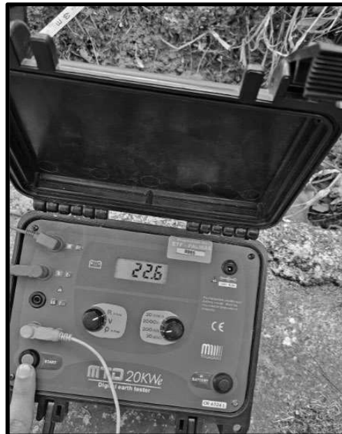
Figura 30 - Resultado no Terrômetro a distância de 23 metros
