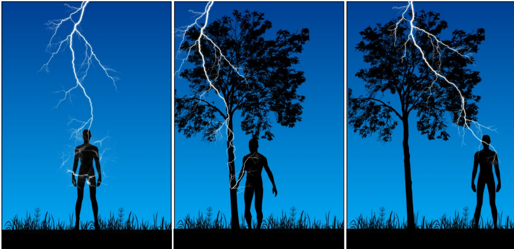
Figura 10 - Situações típicas de acidente por descarga associadas à incidência direta. a) Descarga direta b) Descarga por contato c) Descarga lateral
