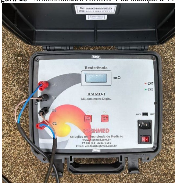
Figura 26 - Miliohmímetro HMMD-1 de medição a 4 fios.
