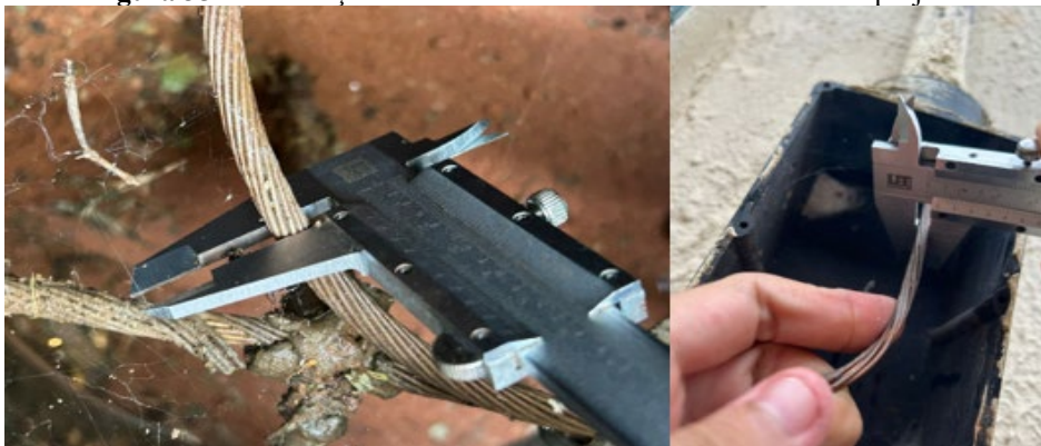
Figura 35 - Verificação do diâmetro das cordoalhas utilizadas no projeto.
