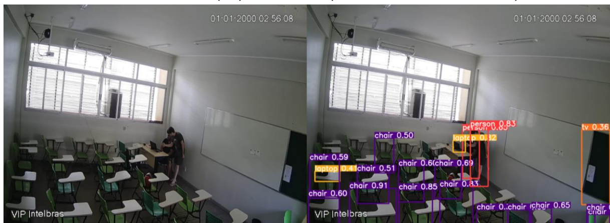
Figura 38: Resultados das inferências realizadas pela IA do YOLOv8 em foto capturada na câmera Intelbras (esquerda – foto capturada; direita - foto analisada)
