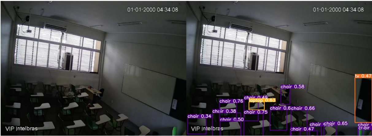
Figura 40: Resultados das inferências realizadas pela IA do YOLOv8 em foto capturada na câmera Intelbras (esquerda – foto capturada; direita - foto analisada)
