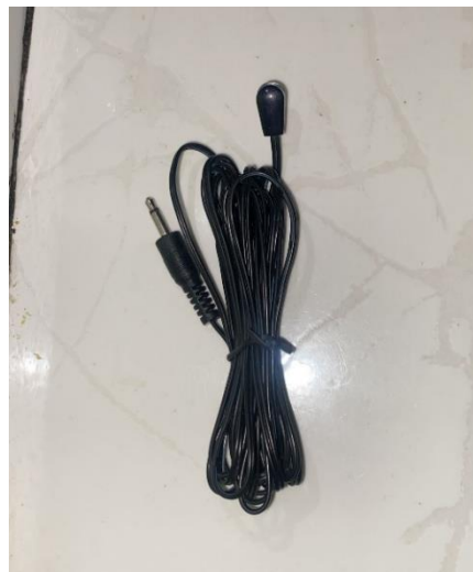
Figura 31: Cabo extensor emissor IR utilizado
