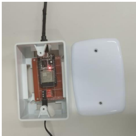
Figura 33: Módulo do Sistema de Controle do Condicionador de Ar
