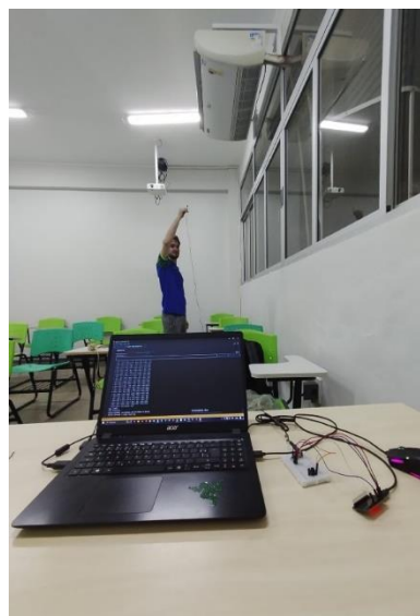
Figura 27: Processo de captura de códigos infravermelho
