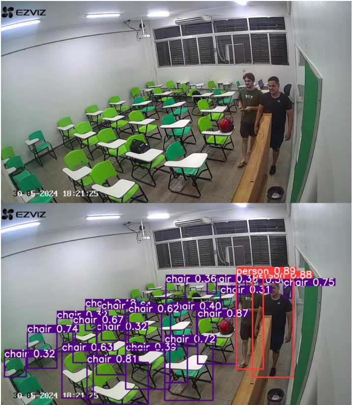
Figura 39: Resultados das inferências realizadas pela IA do YOLOv8 em foto capturada na câmera EZVIZ (em cima – foto capturada; embaixo - foto analisada)
