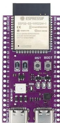
Figura 4 - Placa ESP32 AI-S3 para elaboração do protótipo
