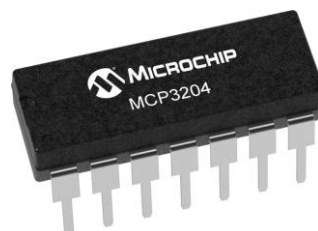
Figura 8 - ADC externo MCP3204
