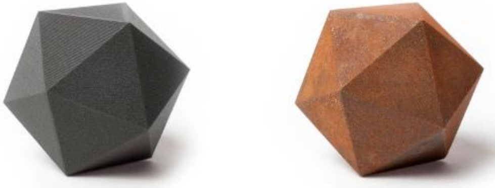
Figura 25. Oxidação do objeto impresso em PLA magnético
