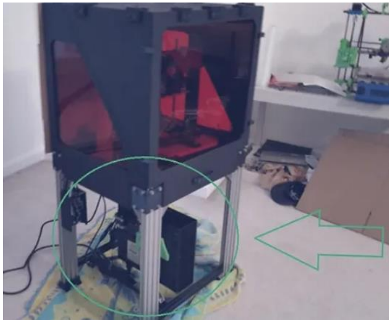
Figura 16. Processamento digital de luz utilizando um projetor
