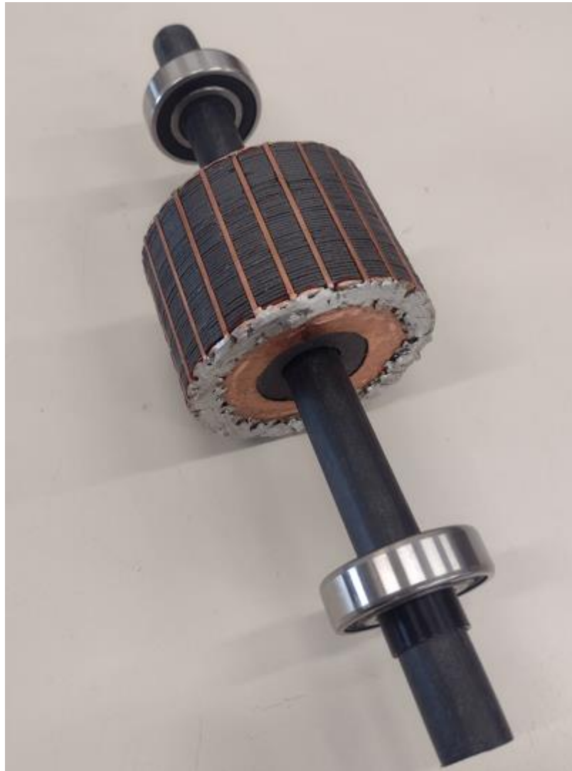
Figura 40. Montagem da estrutura do Rotor.
