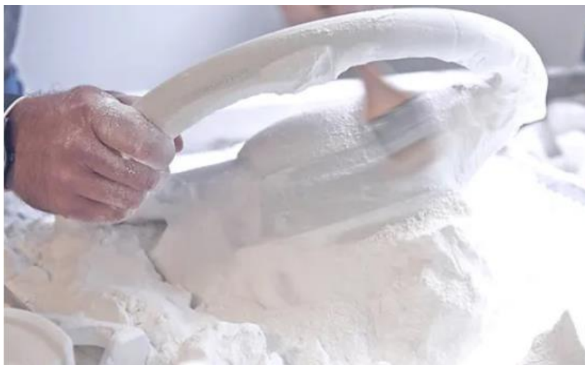
Figura 17. Objeto impresso com tecnologia SLS
