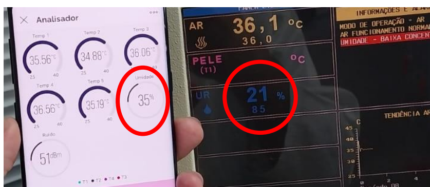
Figura 27 – Comparação entre as leituras de Umidade do analisador e da IN
