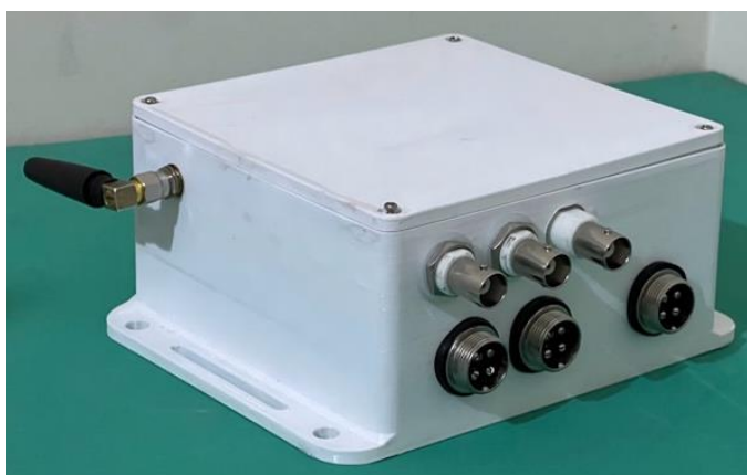
Figura 73 – AceLoRa montada em sua caixa de proteção.
