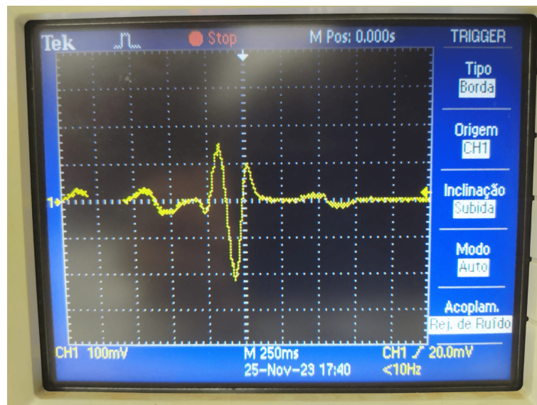
Figura 4.20 – Visualização do sinal na saída do Filtro Passa-Baixas de 2ª ordem.
