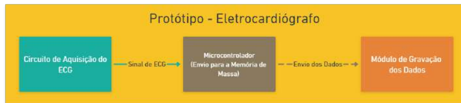
Figura 3.1 – Fluxograma contendo o circuito que será implementado no protótipo.
