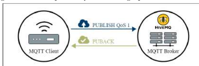
Figura C.4 – Esquema QoS 1: entrega pelo menos uma vez.
