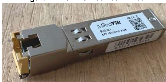
Figura 22 - SFP S-RJ01 da Mikrotik
