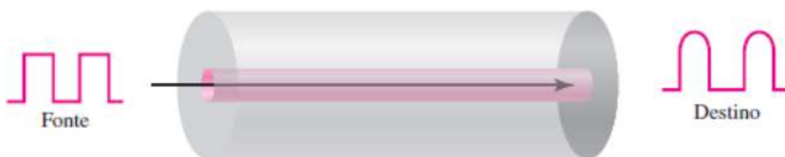
Figura 7 - Distorção da fibra monomodo
