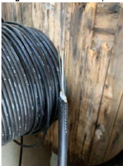
Figura 27 - Cabo de fibra óptica
