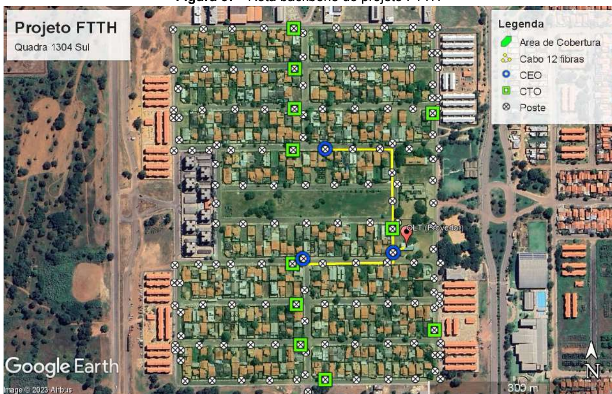
Figura 37 - Rota backbone do projeto FTTH
