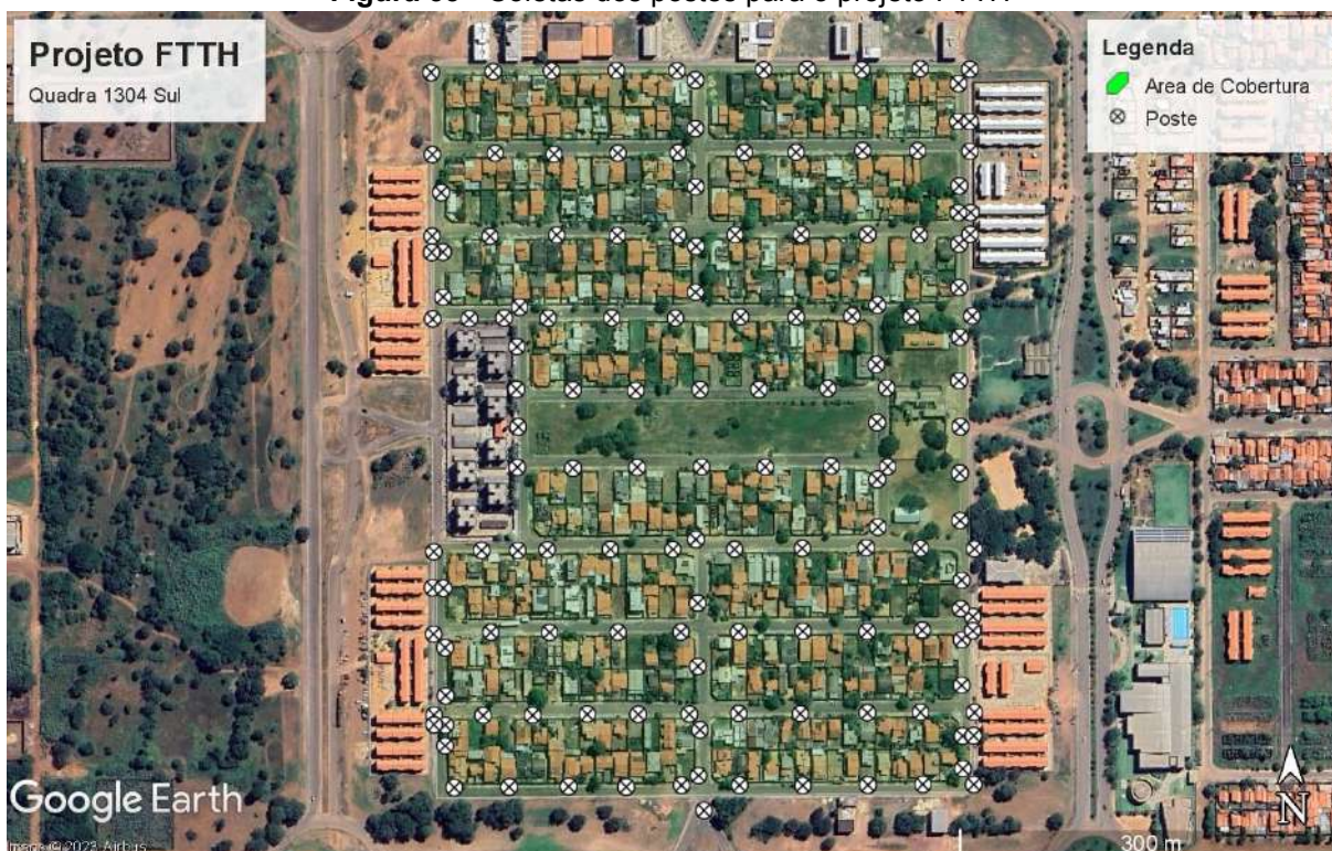
Figura 33 - Coletas dos postes para o projeto FTTH
