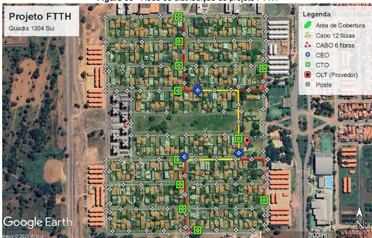
Figura 38 - Rede de distribuição do projeto FTTH
