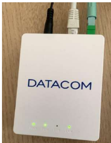
Figura 21 - GPON ONU DM986-100 da DATACOM
