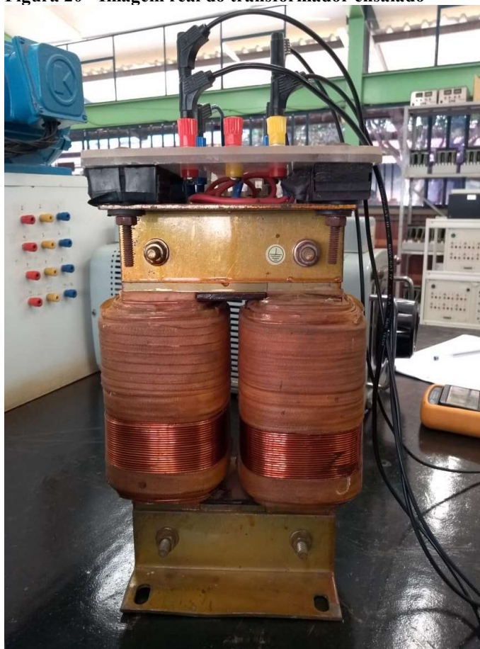
Figura 20 - Imagem real do transformador ensaiado
