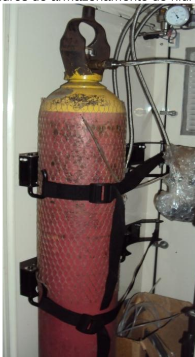
Figura 10 - Cilindros de armazenamento de hidrogênio molecular
