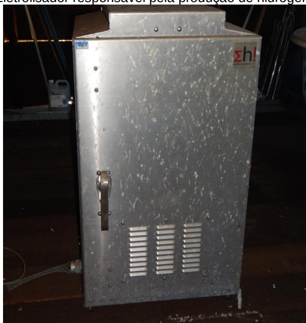
Figura 9 –Eletrolisador responsável pela produção de hidrogênio molecular
