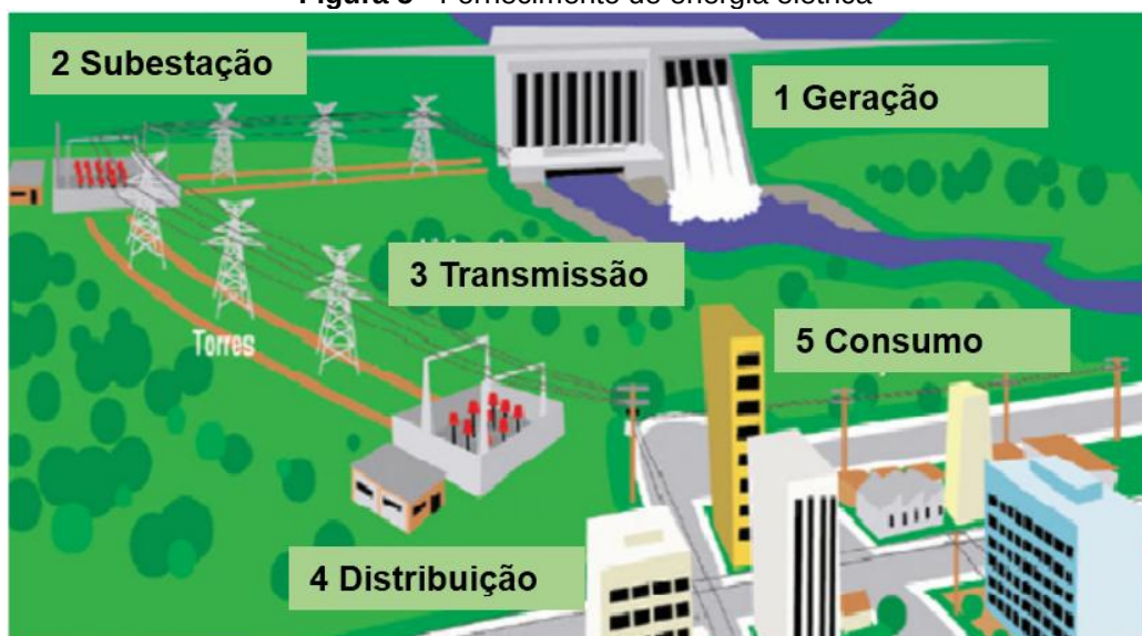
Figura 5 - Fornecimento de energia elétrica
