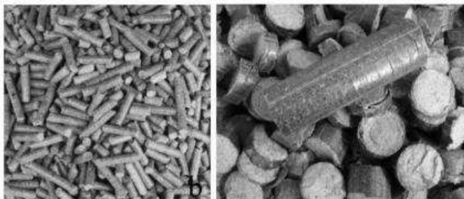
Figura 4 - Péletes (a) e Briquetes (b) de biomassa processada.
