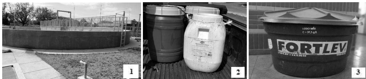
Figura 9. Coleta e armazenamento do "lodo mãe": tanque de equalização (1), coleta e transporte do lodo em galões de 50 e 100 L (2), "lodo mãe" no laboratório de análise de águas (3)
