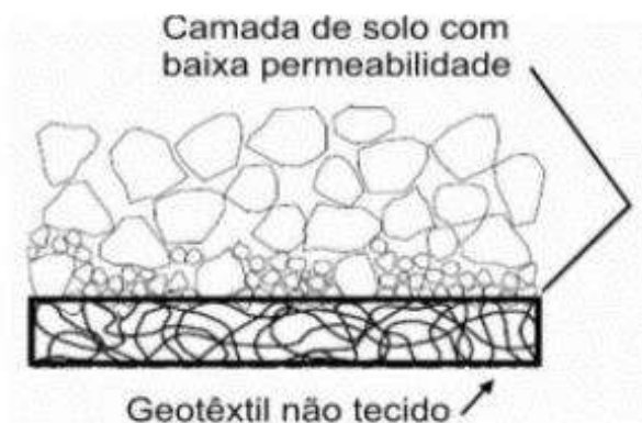
Figura 8. Formação do filter cake
