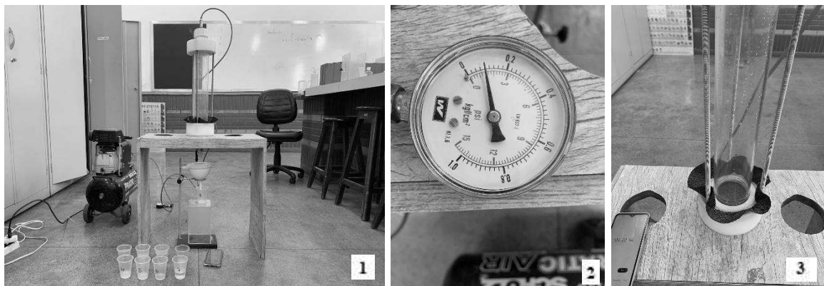
Figura 15. Ensaio com filtro pressurizado em geotêxtil: coleta do material filtrado durante o ensaio (1); Ajuste de pressão para 1,45 Kpi (2); Material sólido retido na membrana geotêxtil (3).
