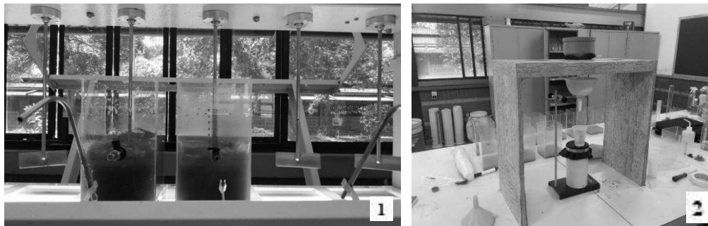
Figura 13. Ensaio de bancada: agitação do lodo com adição de polímero (1), equipamento de filtração em bancada durante o desaguamento do lodo floculado (2).
