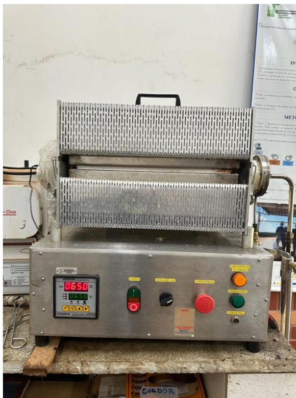
Figura 8 – Reator de leito fixo utilizado em processos de pirólise
