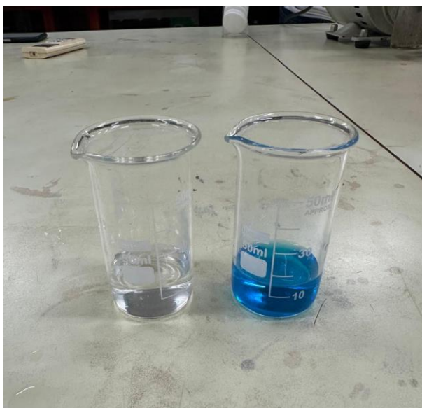
Figura 15 – Solução de concentração 10mg/L antes e após a adsorção
