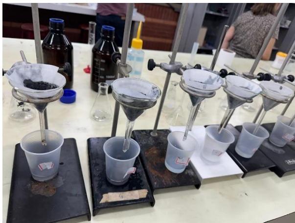
Figura 13 – Processo de filtração da substância adsorvida
