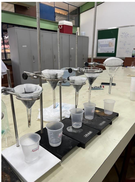
Figura 8 - Processo de filtração da substância adsorvida
