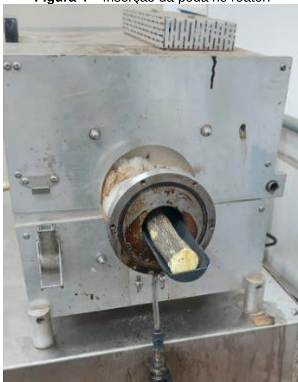
Figura 4 – Inserção da poda no reator.
