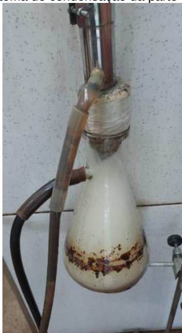
Figura 6 – Sistema de condensação da parte gasosa.
