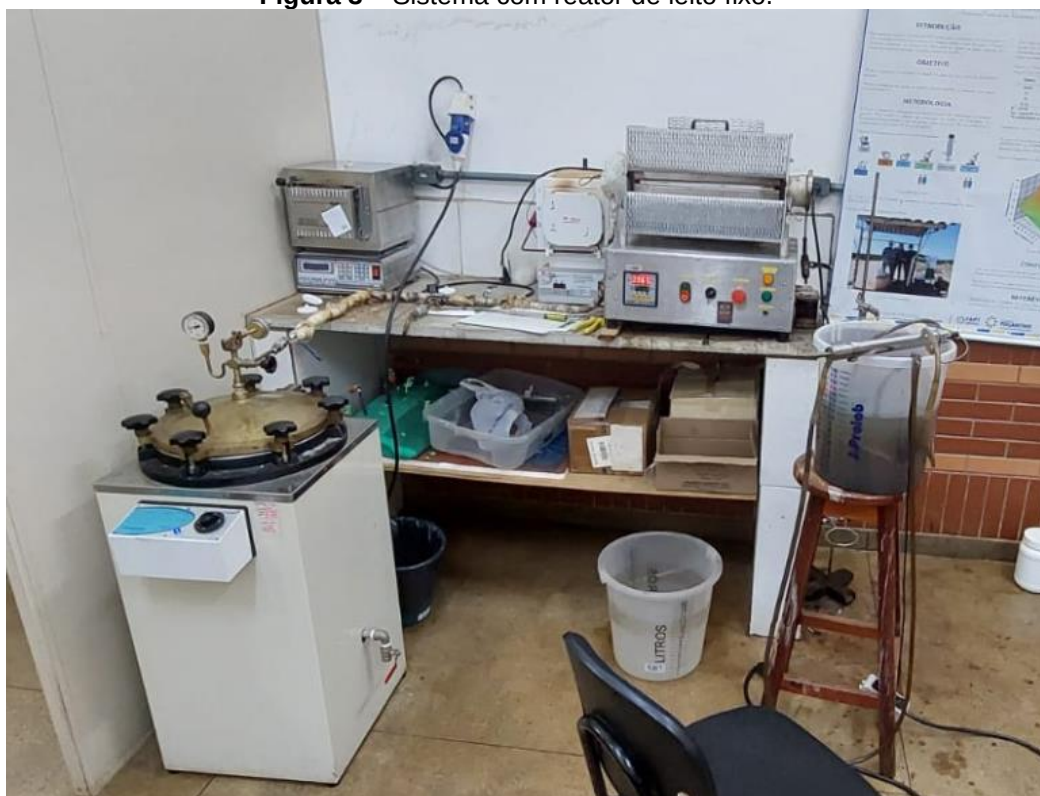
Figura 3 – Sistema com reator de leito fixo.
