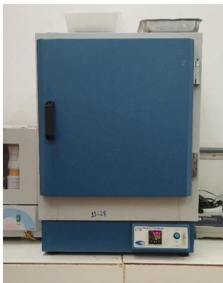
Figura 7 – Estufa utilizada para secagem da amostra
