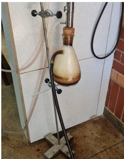
Figura 10 – Sistema de condensação da parte gasosa
