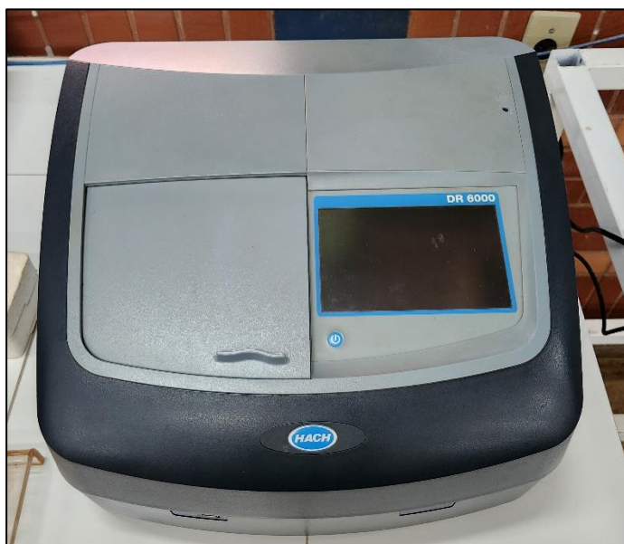
Figura 12 - Espectrofotômetro empregado nos testes
