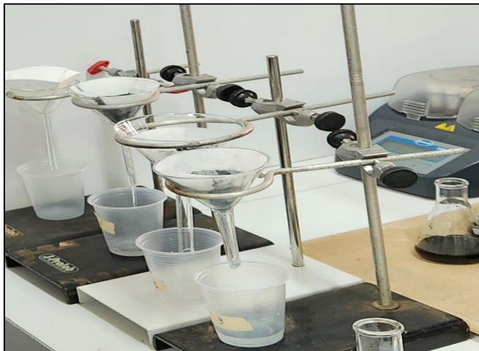
Figura 11 - Filtração para separação de zeólita e material adsorvido
