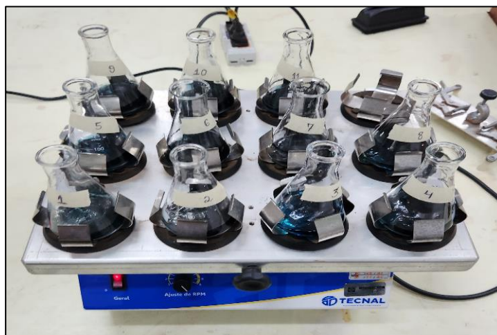
Figura 10 - Mesa agitadora orbital modelo "Shaker TE 141"
