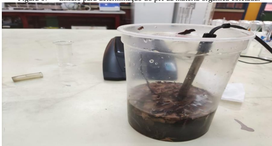
Figura 07 – Ensaio para determinação do pH da matéria orgânica coletada.
