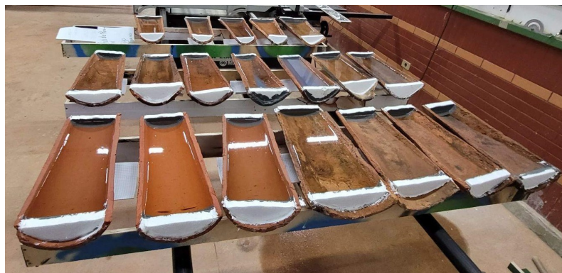
Fotografia 27 - Ensaio de impermeabilidade, molduras preenchidas com água
