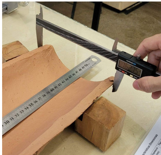
Fotografia 12 - Ensaio de características dimensionais
