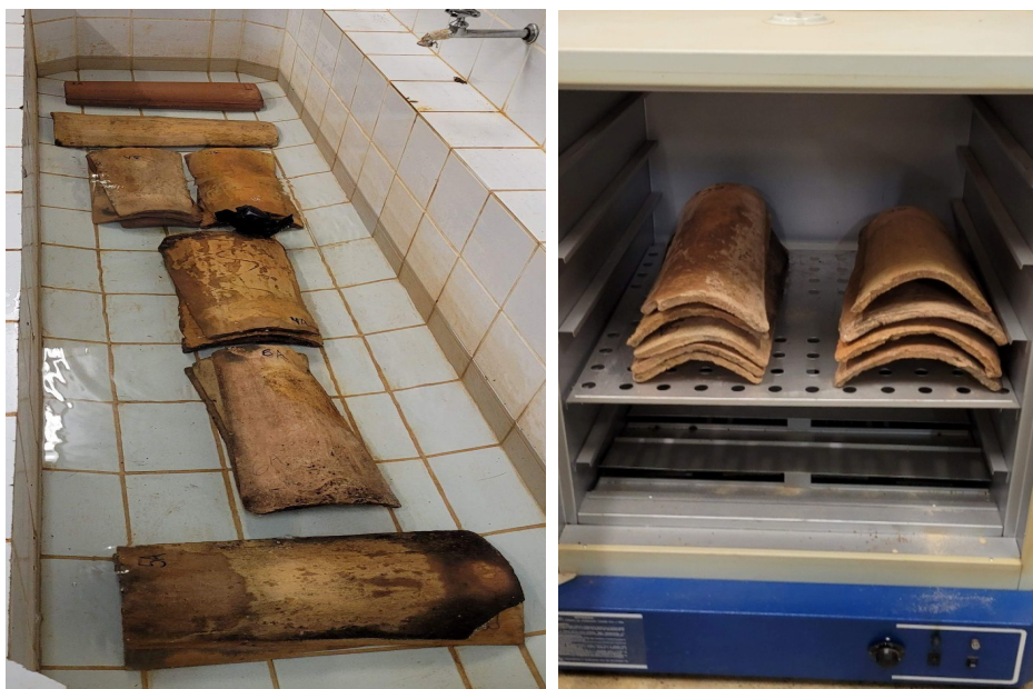
Fotografia 22 e Fotografia 23 - Ensaio de absorção de água, massa úmida
