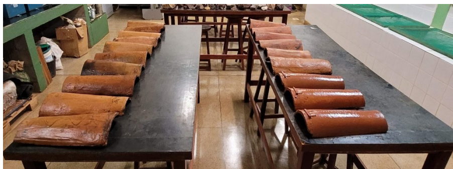
Fotografia 25 - Ensaio de impermeabilidade, resfriamento natural
