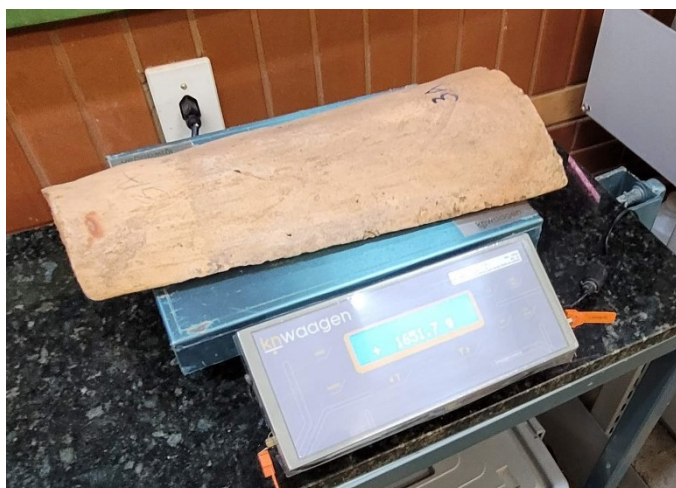
Fotografia 21 - Ensaio de absorção de água, massa seca
