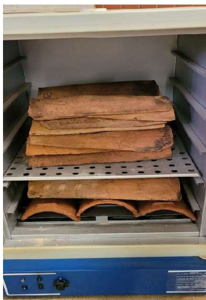
Fotografia 24 - Ensaio de impermeabilidade, secagem das telhas em estufa
