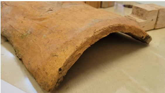
Fotografia 13 - Ensaio de planaridade
