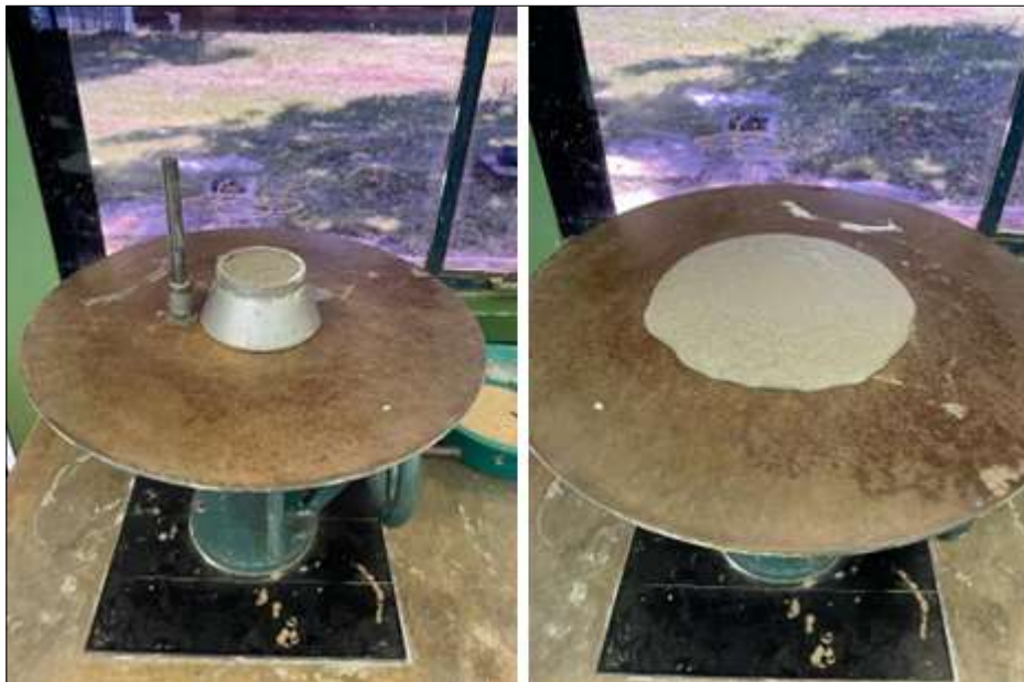
Figura 12. Ensaio de determinação do índice de consistência ( flow table test ).
