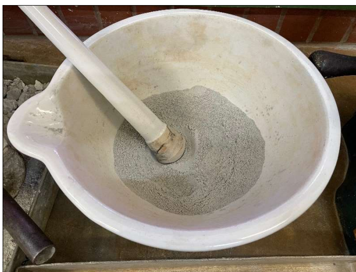
Figura 6. Processo de destorroamento.
