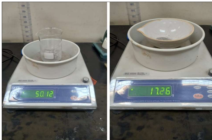
Figura 8. Determinação do índice de finura do material pulverulento.
