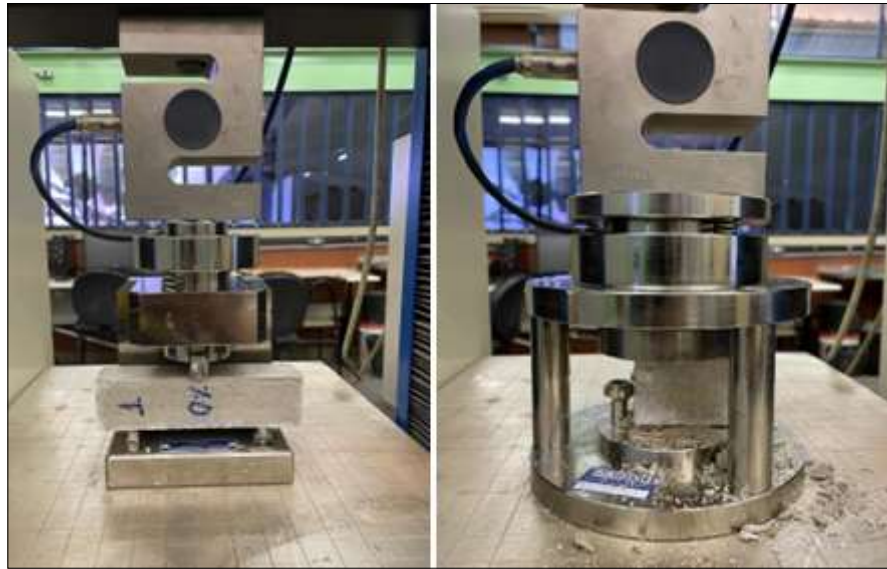
Figura 13. Ensaio de resistência à tração na flexão e resistência a compressão.
