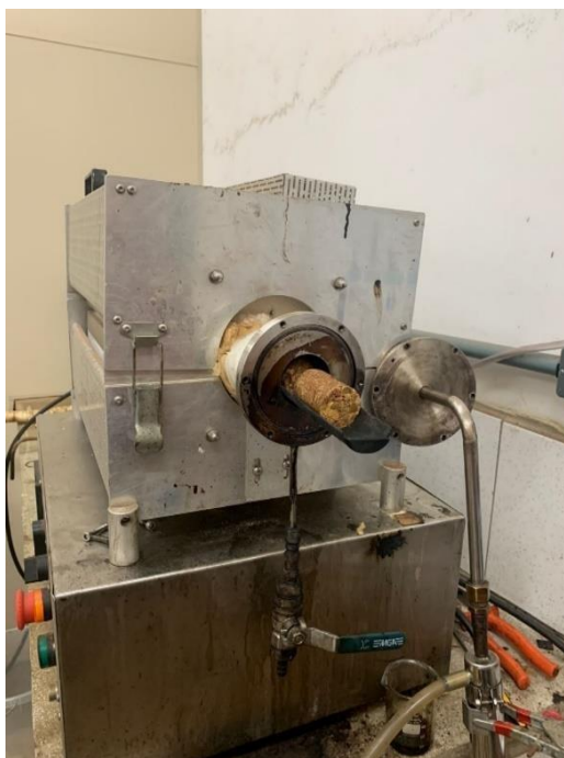
Figura 5: Amostra sendo inserida no reator.
