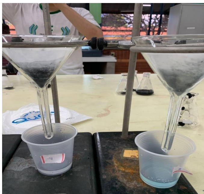
Figura 10: Amostra sendo filtrada em papel analítico.
