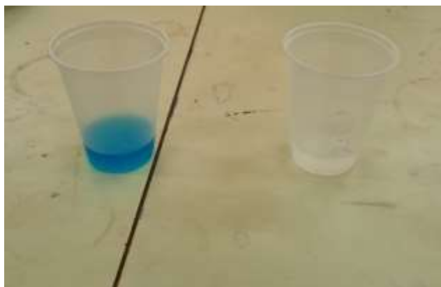
Figura 11 - Solução de concentração 10mg/L antes e após a adsorção
