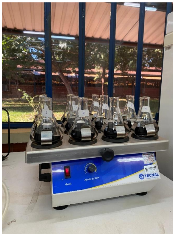
Figura 19: Ensaio de adsorção, com as 11 amostras na mesa agitadora.
