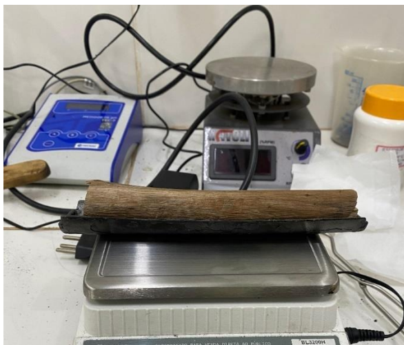
Figura 17: Barca com biomassa residual do eucalipto antes da pirólise.
