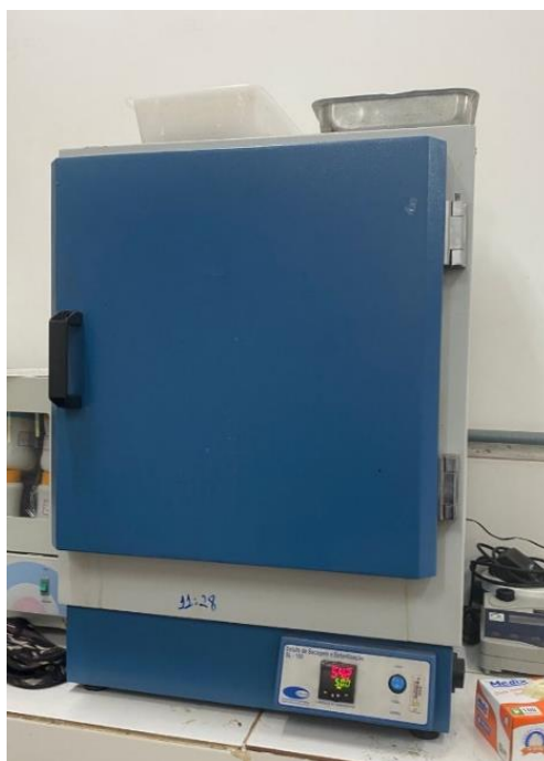
Figura 8: Estufa a ser utilizada para secagem da amostra.
