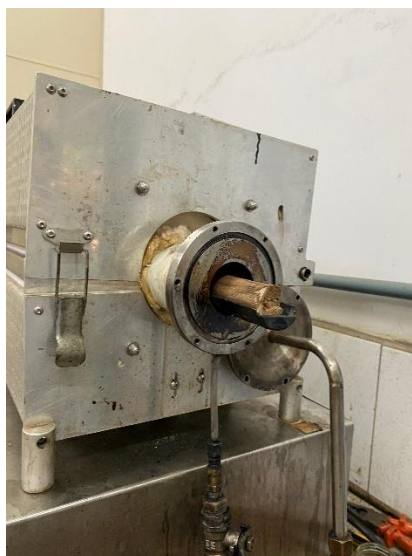
Figura 14: – Introdução da biomassa no reator para o início da pirólise.
