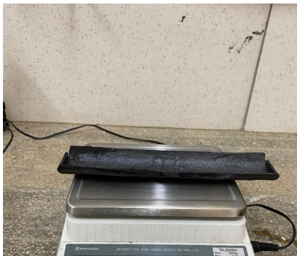
Figura 18: Barca com carvão ativado obtido do processo de pirólise.
