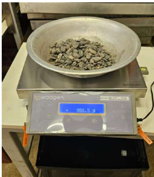
Figura 7 – Pesagem do agregado graúdo seco
