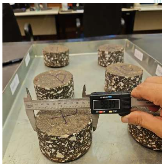
Figura 4 – Aferição de diâmetro do corpo de prova
