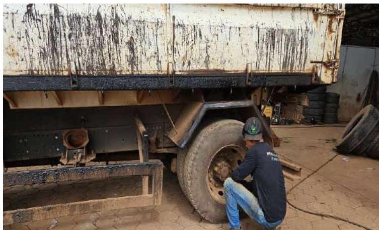
Figura 4 – Calibração dos pneus
