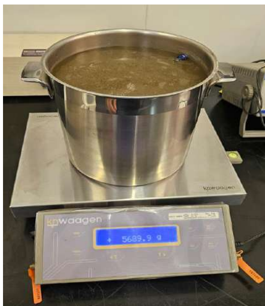
Figura 12 – Pesagem da amostra com água destilada completada
