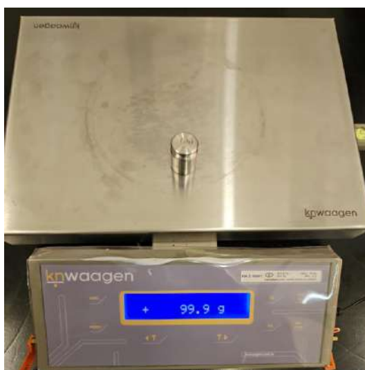
Figura 6 – Calibração da balança
