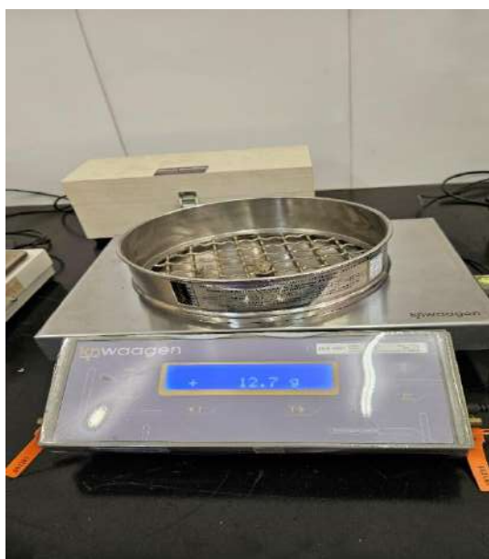
Figura 10 – Pesagem do conteúdo retido em cada peneira
