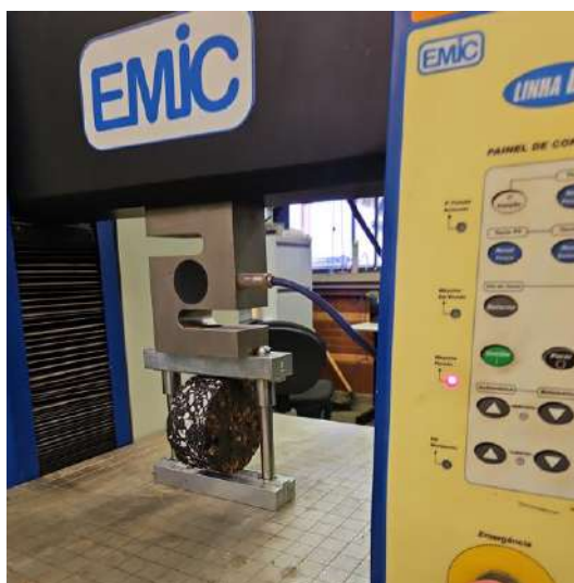
Figura 15 – Posicionamento da célula no adaptador
