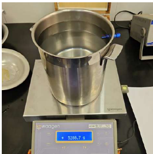
Figura 14 – Recipiente cheio com água destilada
