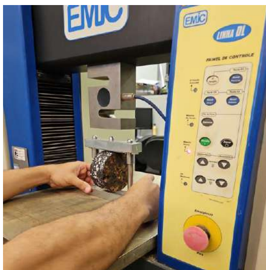
Figura 14 – Posicionamento do corpo de prova na prensa
