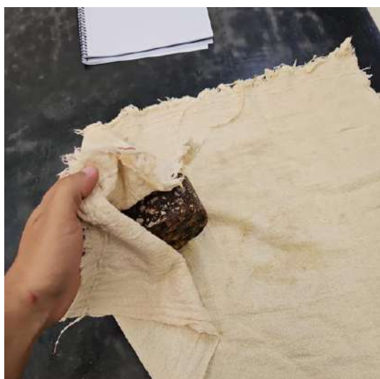
Figura 11 – Secagem do Corpo de Prova
