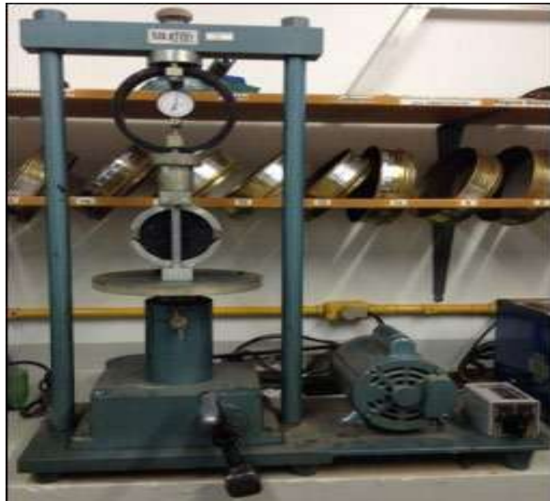
Fotografia 6 - Prensa de ensaio de estabilidade e fluência
