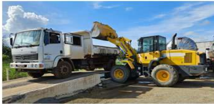
Figura 3 – Pesagem do eixo traseiro com carga
