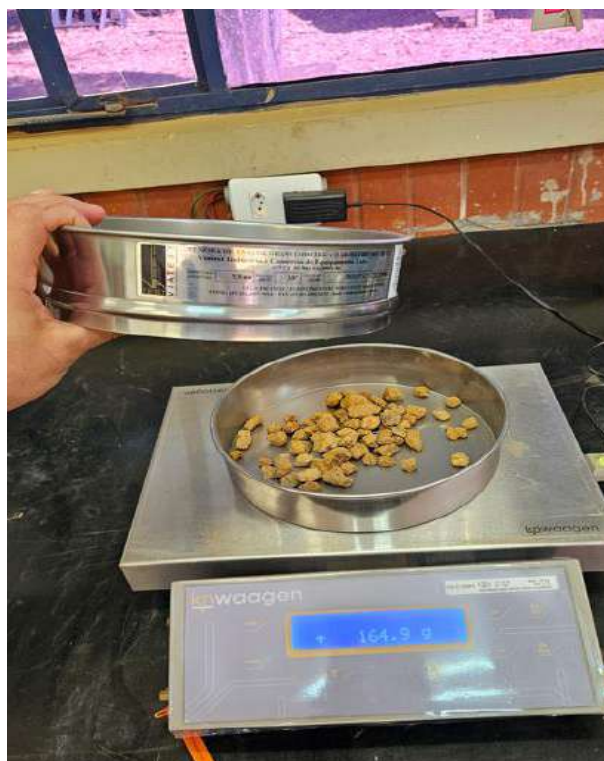
Figura 12 – Parte da amostra retida na peneira
