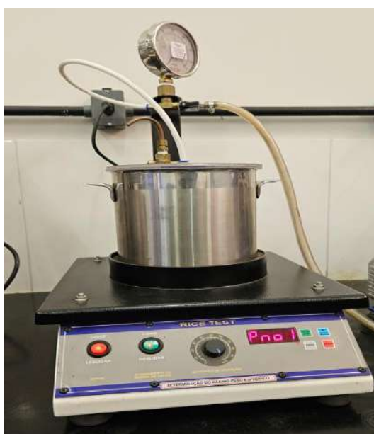
Figura 10 – Amostra fixada e tampada na mesa agitadora
