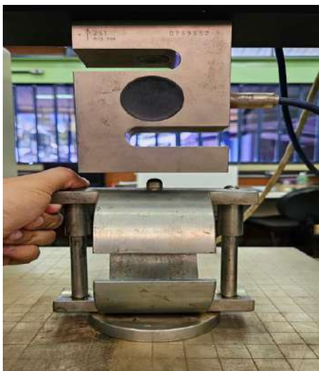
Figura 13 – Ajuste de subida de adaptador
