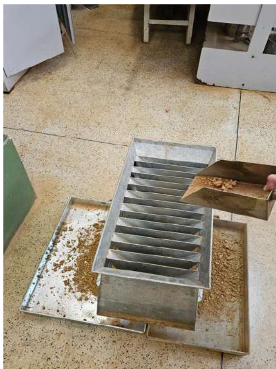
Figura 7 – Quarteamento de 5 kg de amostra
