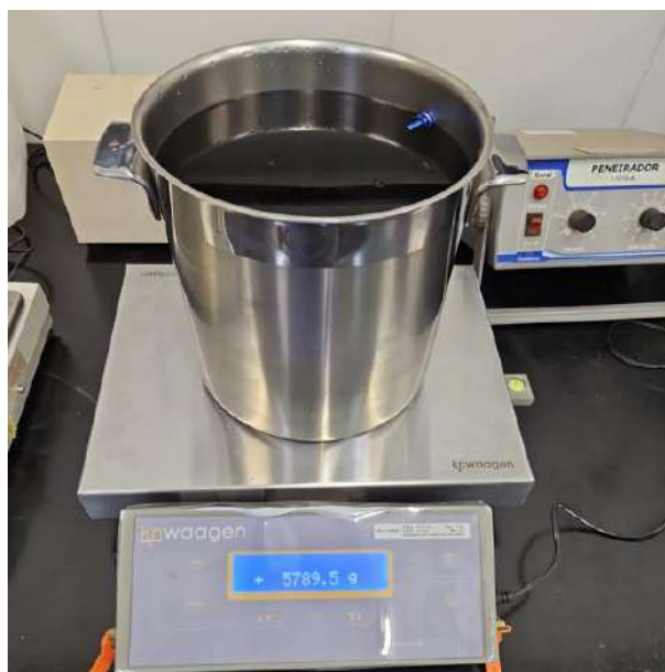
Figura 13 – Pesagem da amostra com água destilada completada
