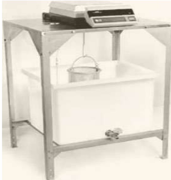
Fotografia 4 - Amostra de agregado graúdo em pesagem hidrostática
