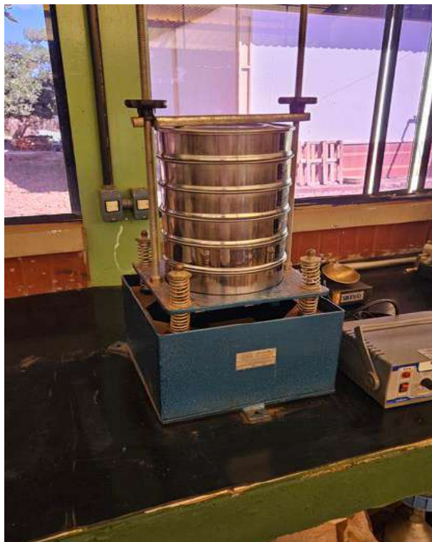
Figura 11 – Posicionamento da Amostra no agitador mecânico
