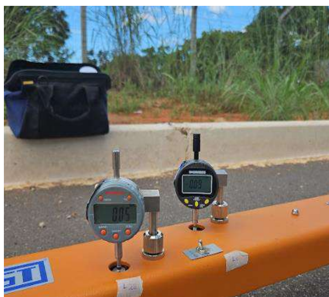
Figura 10 – Leitura dos inicial extensômetros
