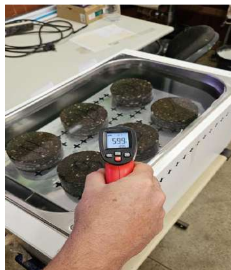
Figura 16 – Aferição de temperatura
