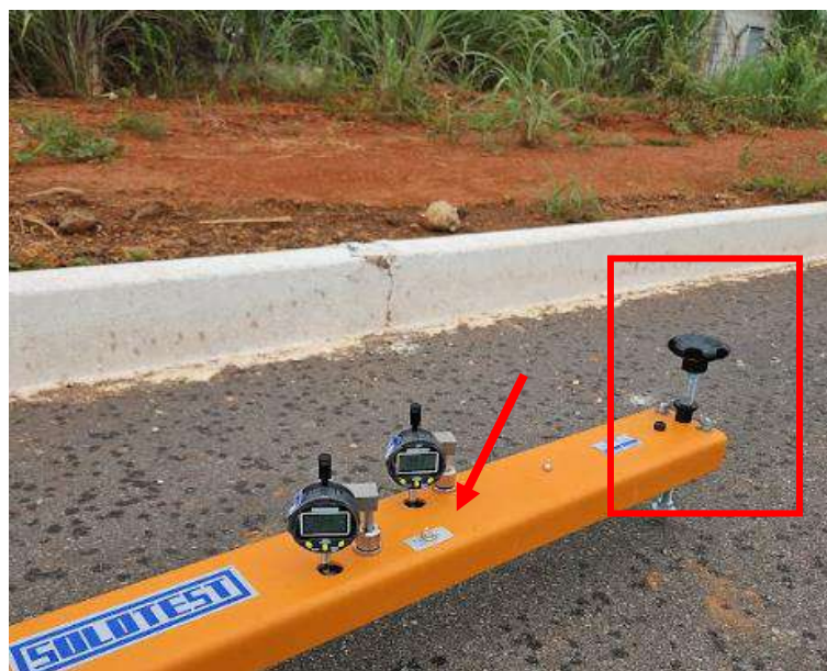
Figura 9 – Ajuste do pé traseiro da Viga
