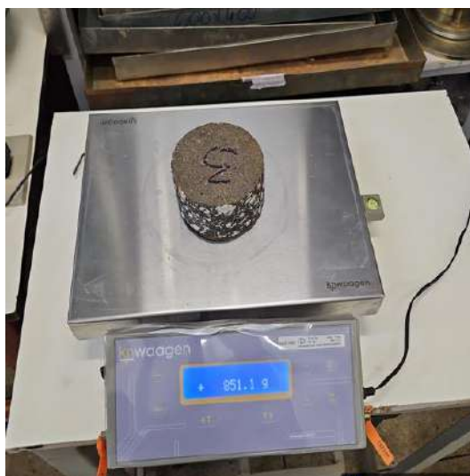
Figura 7 – Pesagem do Corpo de Prova seco
