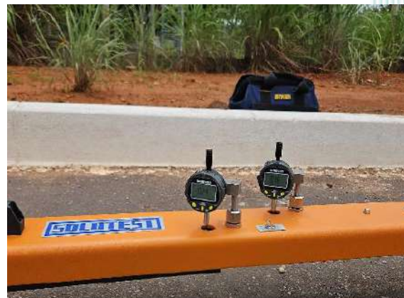
Figura 12 – Leitura final dos extensômetros
