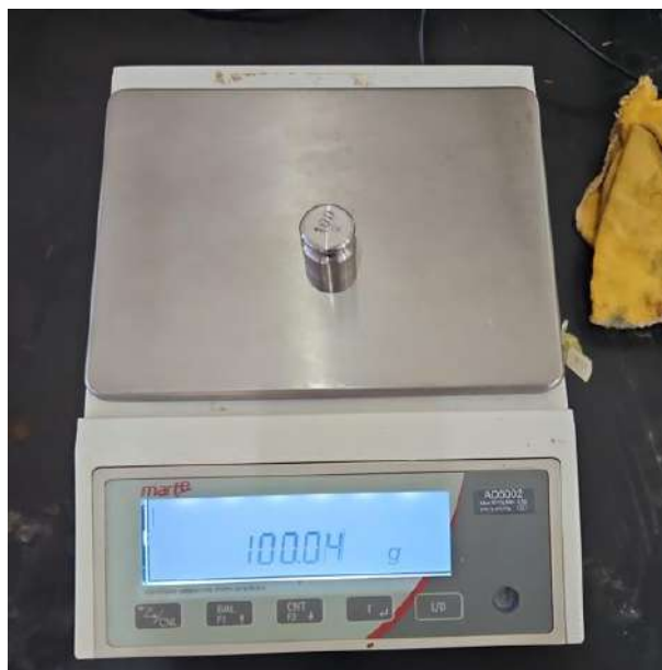
Figura 6 – Calibração da balança
