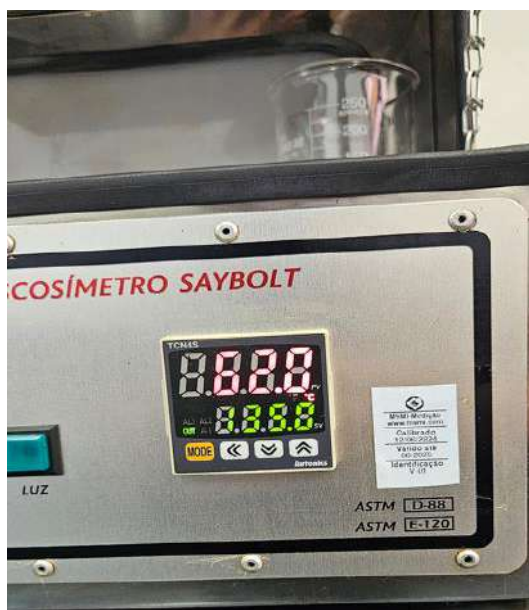
Figura 4 – Pré-aquecimento do viscosímetro Saybolt - Furol
