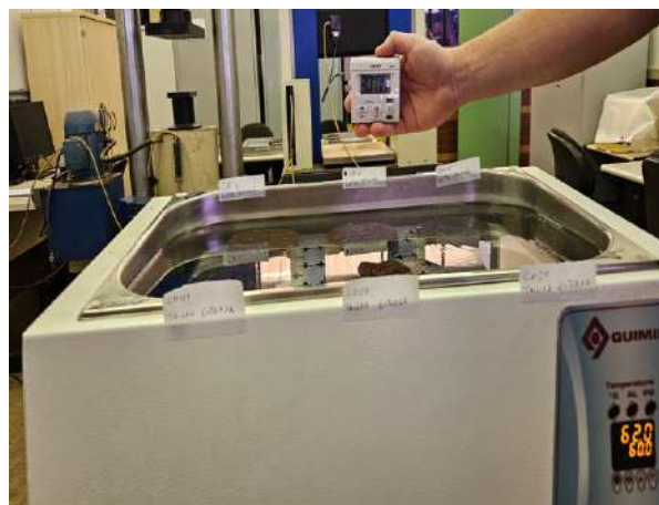
Figura 15 – Imersão dos corpos de prova em banho maria
