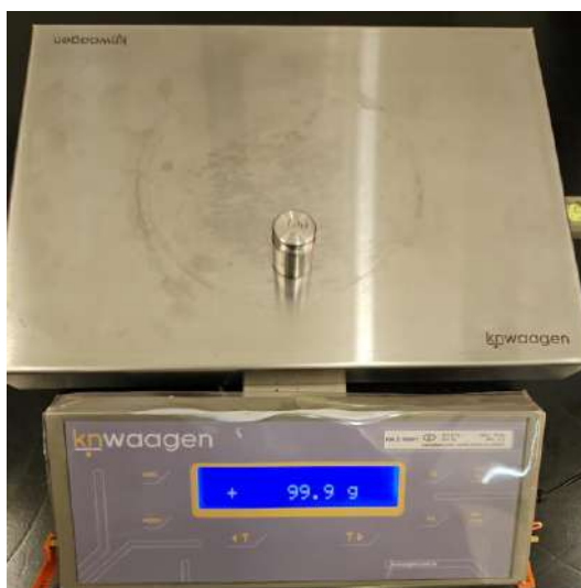
Figura 6 – Calibração da balança
