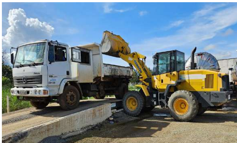
Figura 3 – Pesagem do eixo traseiro com carga
