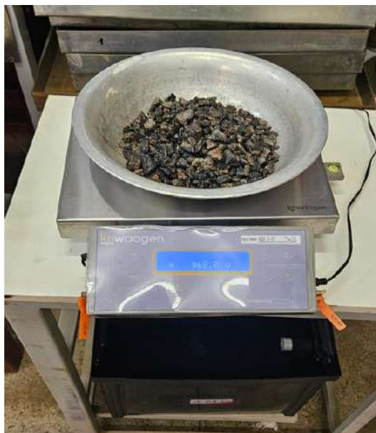
Figura 12 – Pesagem do agregado gráudo seco
