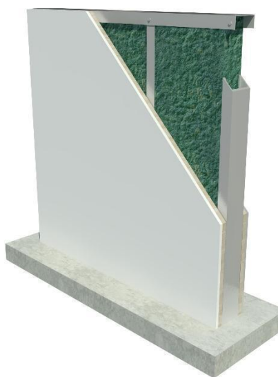
Figura 8 - Vedação em Steel Frame
