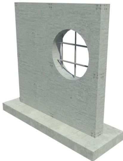
Figura 5 - Parede de concreto moldada in loco
