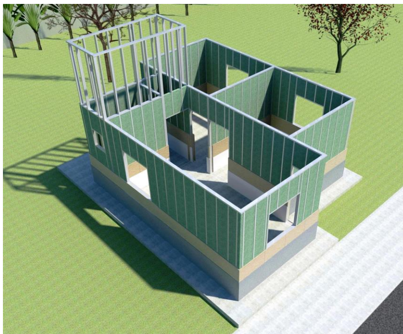
Figura 9 - Estrutura em Steel Frame
