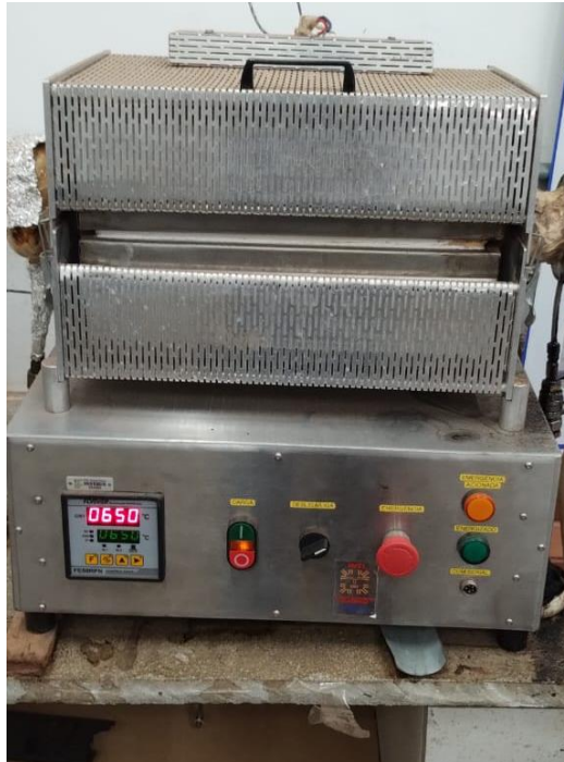
Figura 6- Reator de leito fixo que foi utilizado no ensaio de pirólise.
