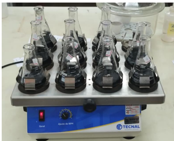
Figura 8 - Mesa de agitação (Shaker TE 141) utilizada.
