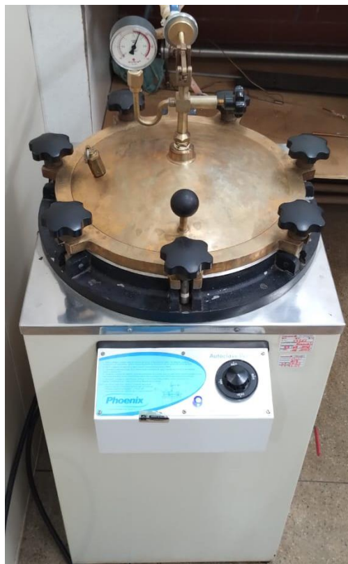
Figura 7- Sistema de produção de vapor que foi utilizado no ensaio de pirólise.
