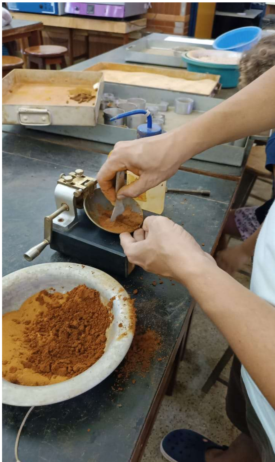
Figura 3.8 – Ensaio de limite de Liquidez com aparelho Casagrande, permite determinação do menor teor e umidade com que uma amostra de solos pode fluir. Fonte: Pereira et al. (2024)
