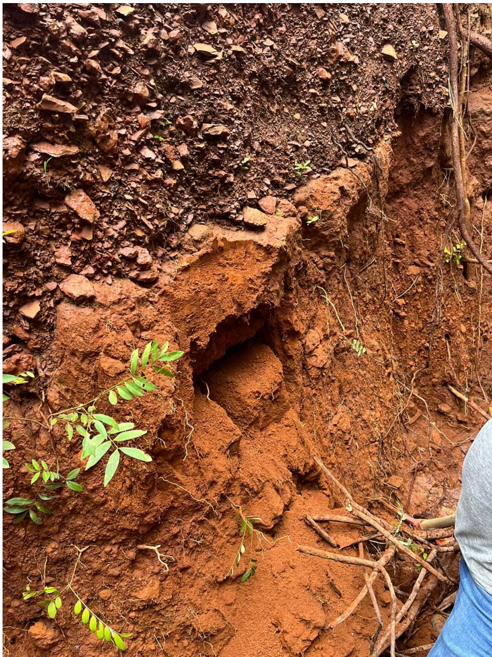
Figura 3.5 – Mostra como foi feito a coleta do corpo de prova para análise em laboratório escavando o talude com cuidado para retirada de amostra indeformada para estudo em laboratório. Fonte: Pereira et al. (2024)
