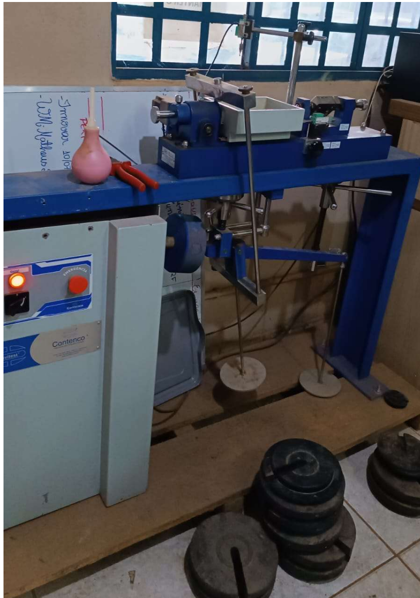
Figura 3.10 – Mostra a imagem de equipamento para cisalhamento direto do laboratório da Empresa Técnica Engenharia. Fonte: Pereira et al. (2024)
