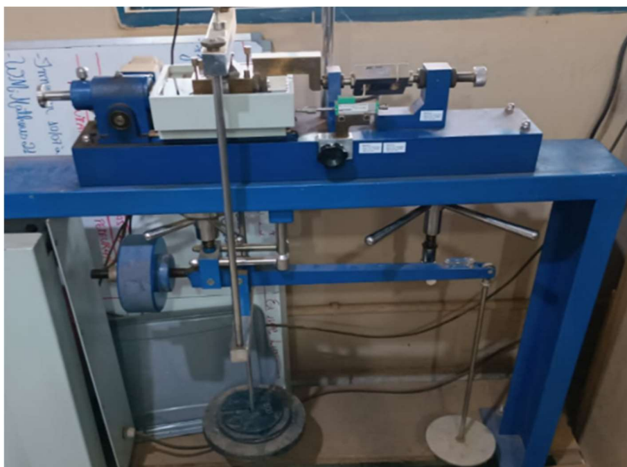
Figura 4.7 – Realização do ensaio de cisalhamento direto com parceria da Empresa Técnica Engenharia. Fonte: Pereira et al. (2024)
