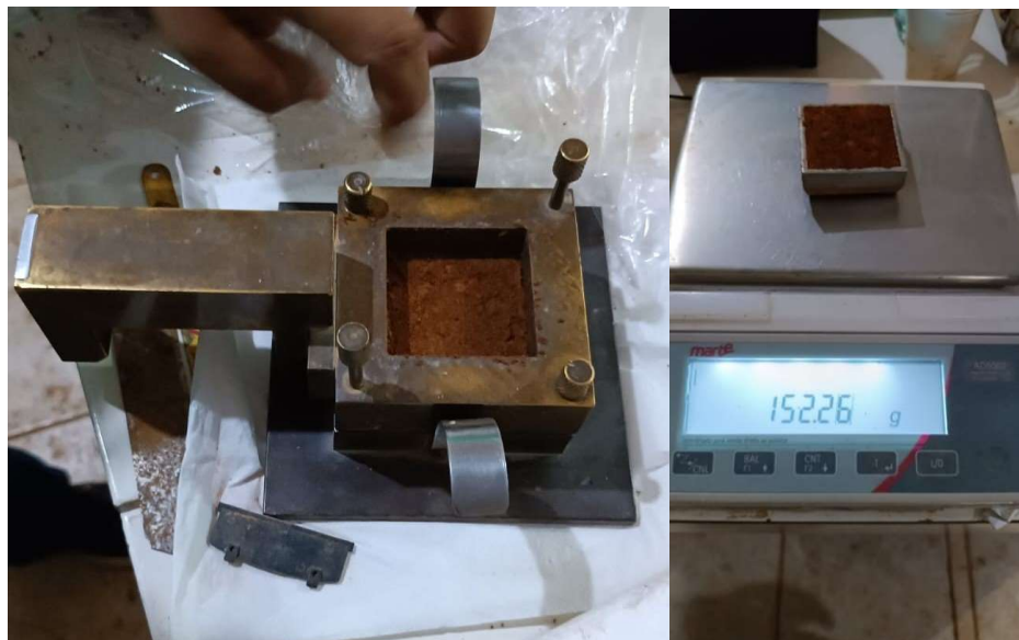
Figura 4.6 – Moldagem de corpos de provas e pesagem do molde com solo úmido provenientes de amostra indeformada para execução do ensaio de cisalhamento direto. Fonte: Pereira et al. (2024)
