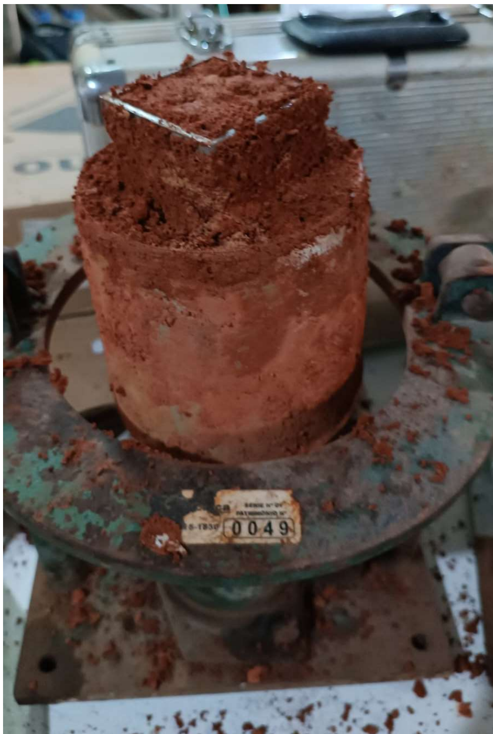
Figura 3.9 – Mostra à amostra indeformada retirada em cilindro metálico para moldagem do corpo de prova em molde de caixa cisalhante para ensaio de cisalhamento. Fonte: Pereira et al. (2024)
