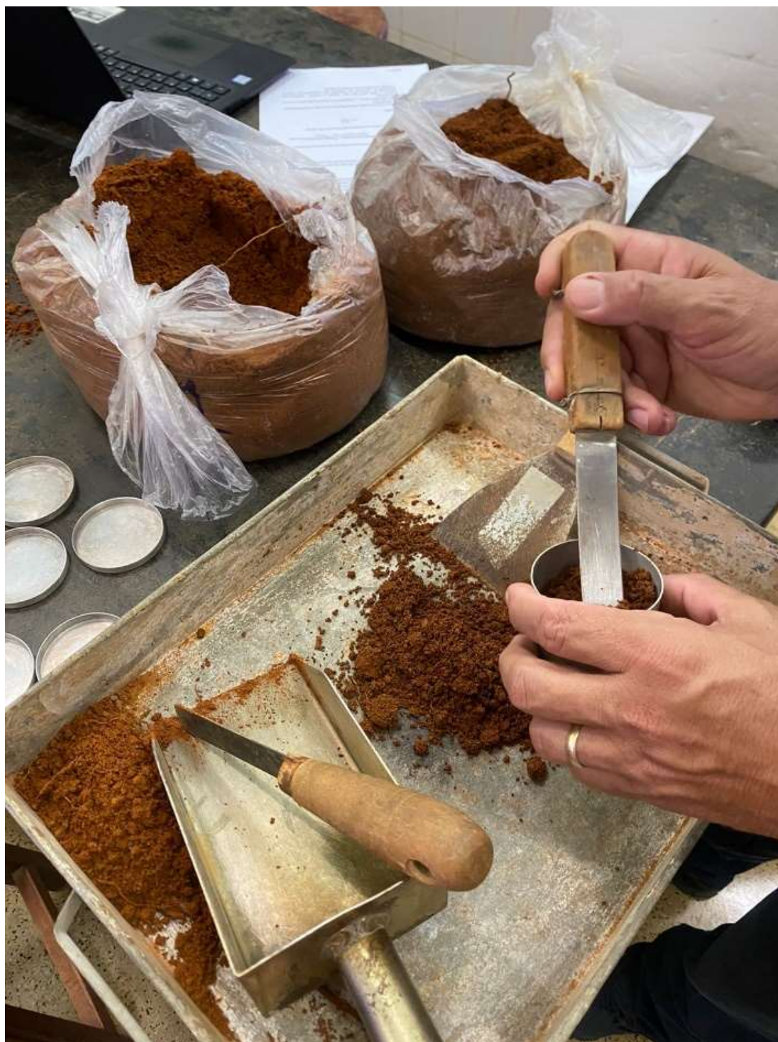
Figura 3.7 – Teor de umidade – realizando ensaio de teor umidade no laboratório do IFTO. Fonte: Pereira et al. (2024)
