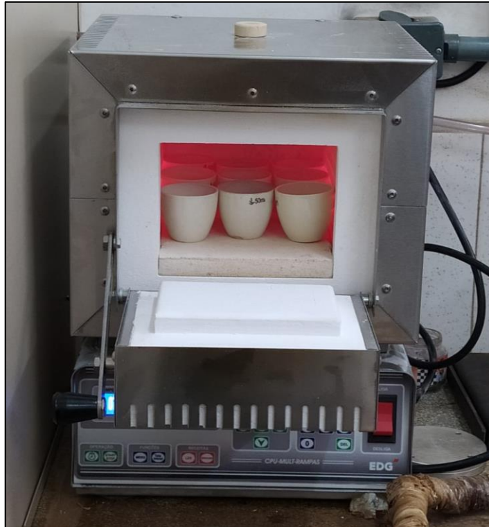
Figura 14 – Forno tipo mufla aquecido com cadinhos em seu interior
