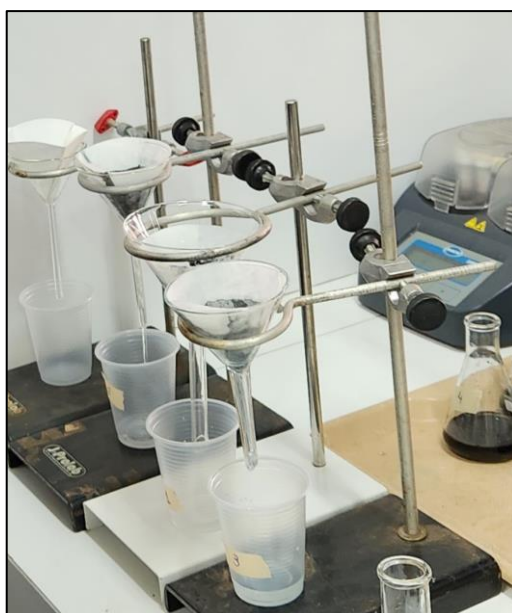
Figura 23 – Processo de filtração da substância adsorvida
