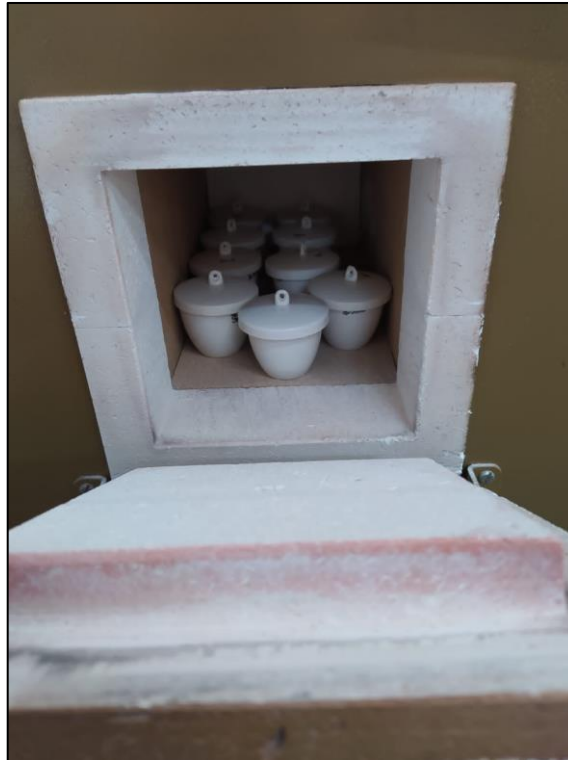
Figura 15 – Forno mufla com cadinhos no interior
