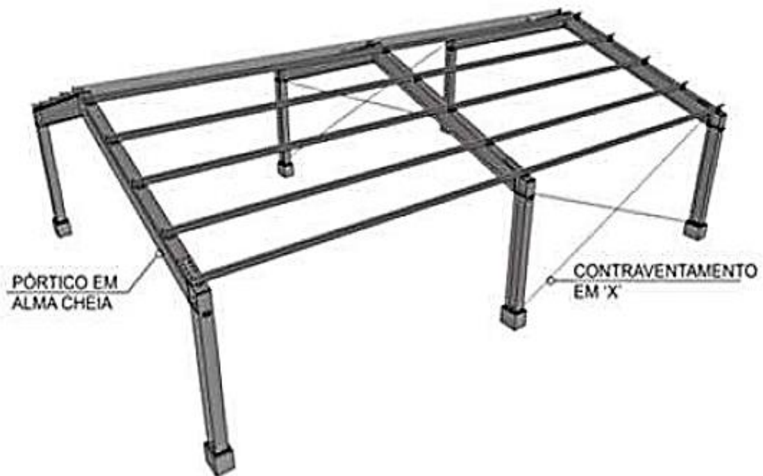
Figura 15 - Edifício industrial com colunas e vigas de alma cheia
