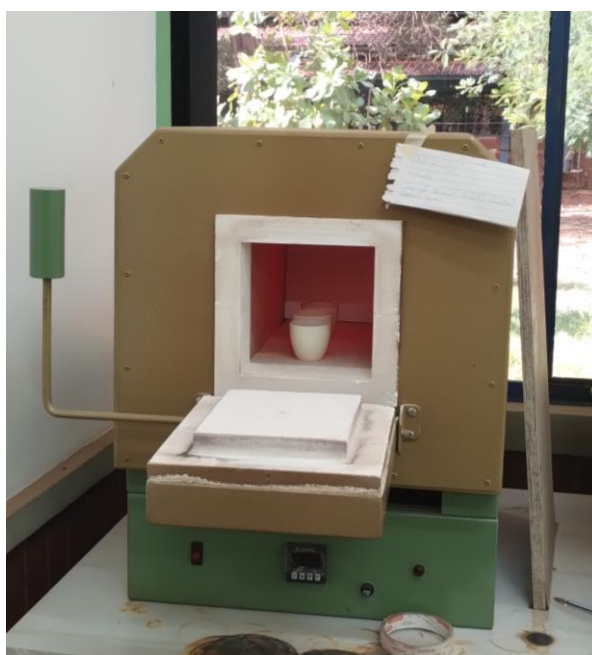
Figura 10 - Forno Mufla, recolhimento de cadinhos.
