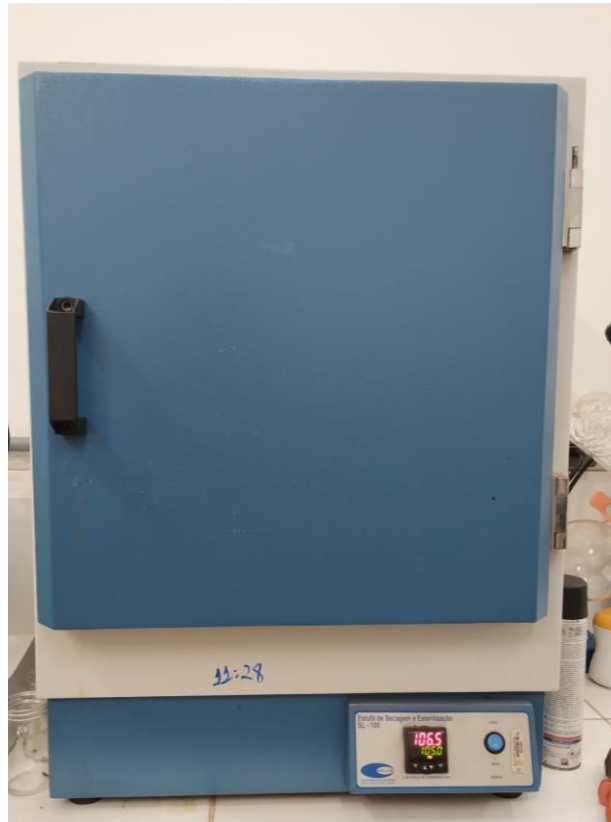
Figura 8 - Forno Mufla usado na determinação de teor de umidade.
