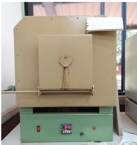
Figura 11 Forno Mufla usado na determinação dos teores de cinzas e material volátil.
