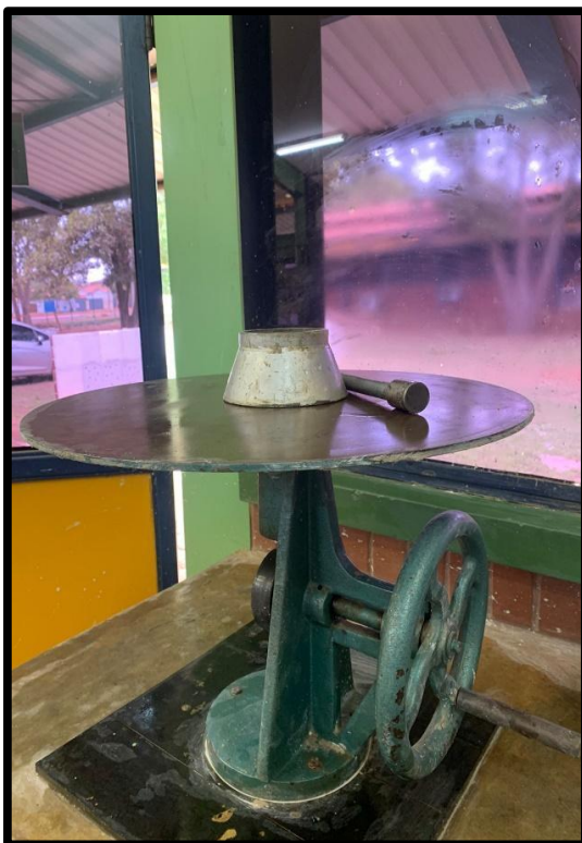
Sequência Executiva: Massa após 15,10,5 golpes e remoção do molde de consistência
