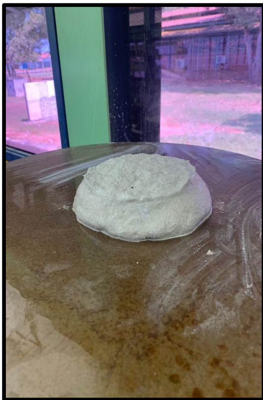
Sequência Executiva: Massa após 15,10,5 golpes e remoção do molde de consistência
