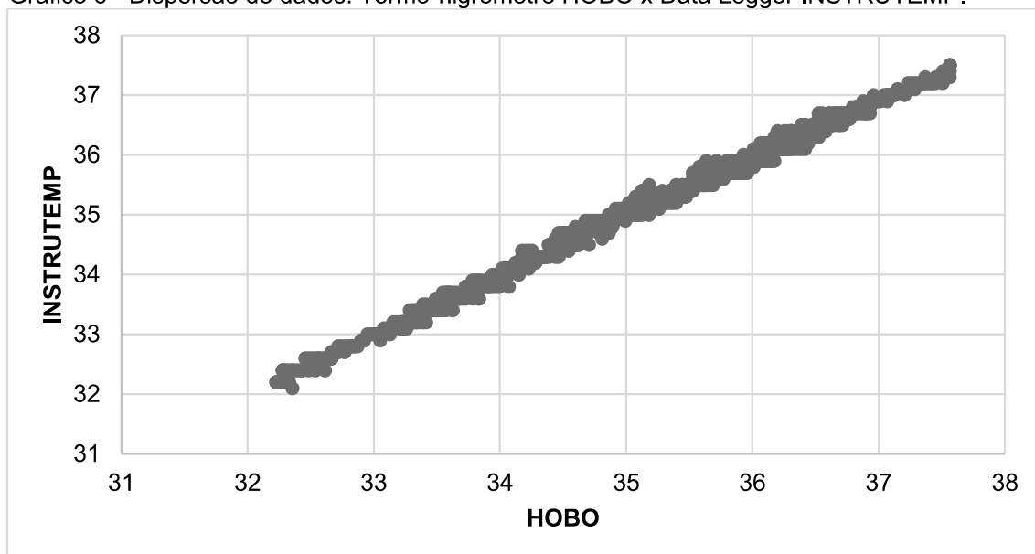
Gráfico 6 - Dispersão de dados: Termo-higrômetro HOBO x Data Logger INSTRUTEMP.
