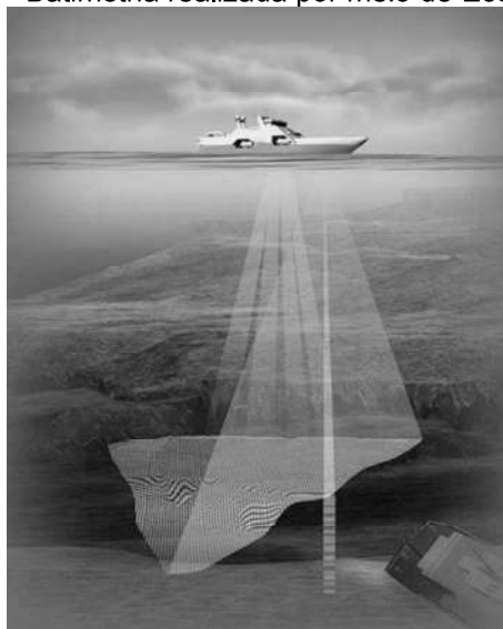
Figura 10 - Batimetria realizada por meio de Ecobatímetros
