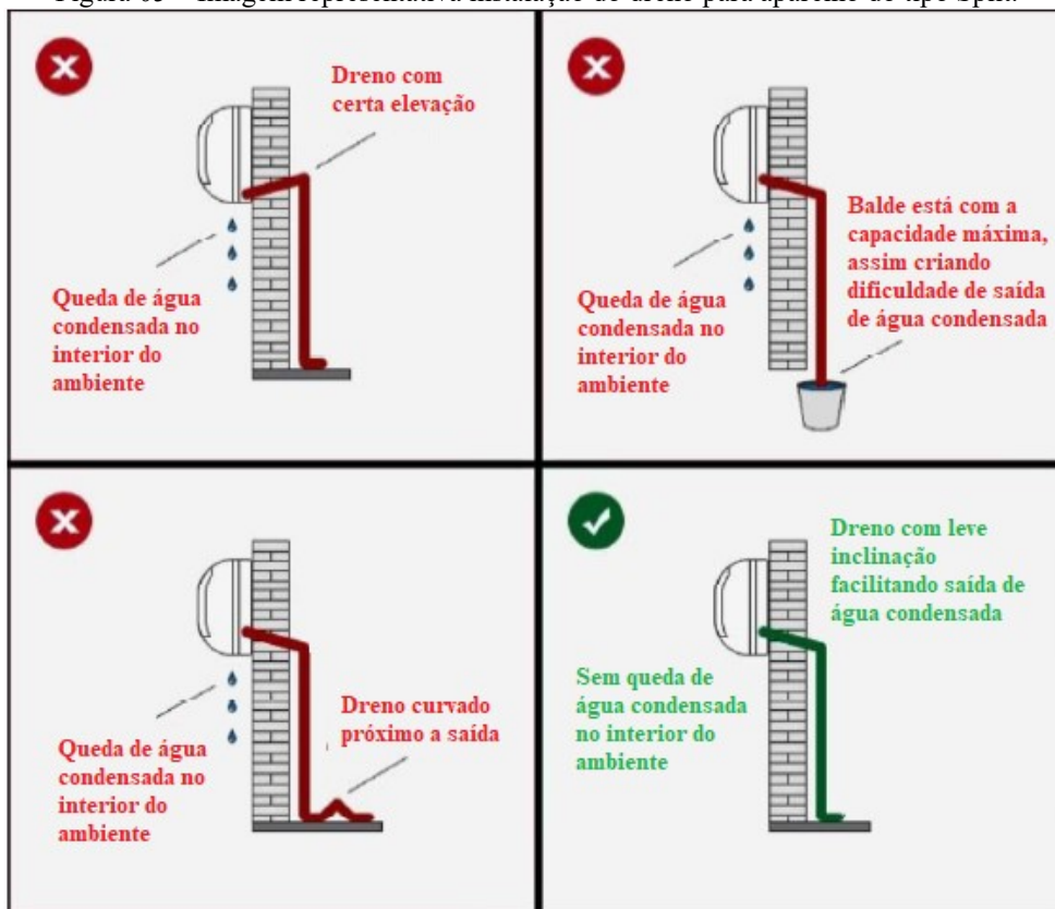
Figura 05 – Imagem representativa instalação do dreno para aparelho do tipo Split.
