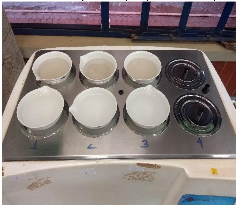
Figura 19: Procedimento para a evaporação da amostra (banho maria)
