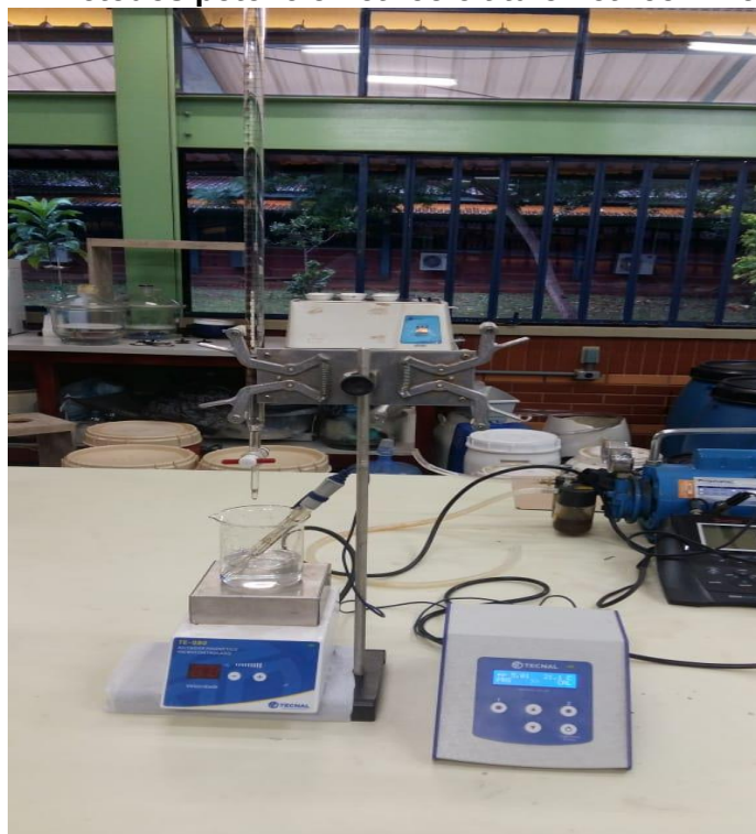
Figura 22: Métodos potenciométrico e titulométrico - Alcalinidade.
