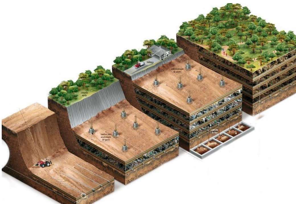
Figura 1: Desenho esquemático de um aterro sanitário.
