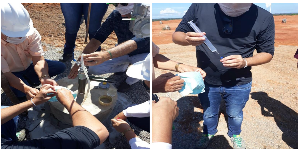
Figura 18: Coleta de biogás no Aterro Sanitário de Palmas – Tocantins: (a) drenagem do biocombustível e (b) coleta de amostra para posterior análise.
