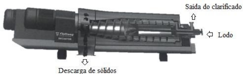
Figura 6 - Princípio de funcionamento de centrífugas empregadas na desidratação de resíduos
