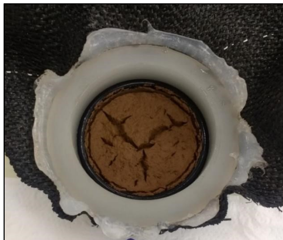
Figura 26 - Resíduo retido no geotêxtil
