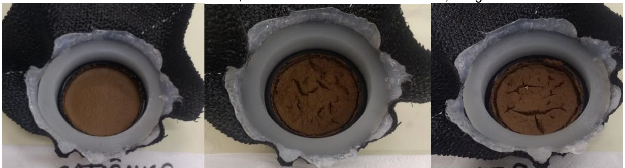
Figura 33 - Aspecto do geotêxtil ao final dos ensaios 7, 8 e 9 (esquerda para direita), utilizando Polímero Catiônico, com SST inicial do resíduo de 10,125 g/L
