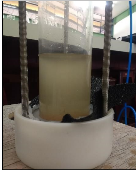
Figura 25 - Resíduo no filtro pressurizado
