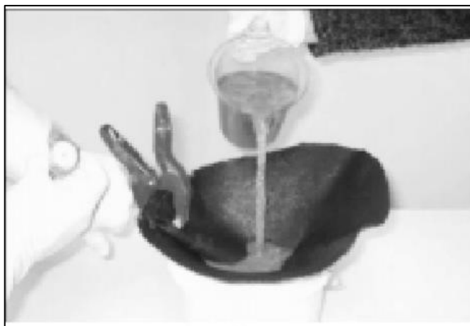
Figura 11 - Montagem do ensaio de cone em geotêxtil
