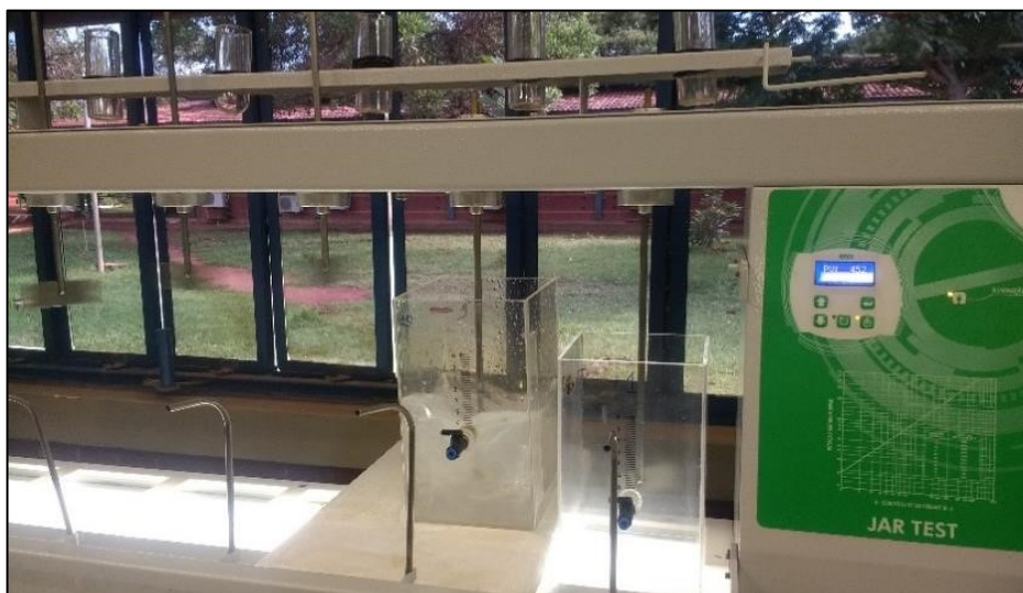
Figura 23 - Preparação do polímero para ensaio
