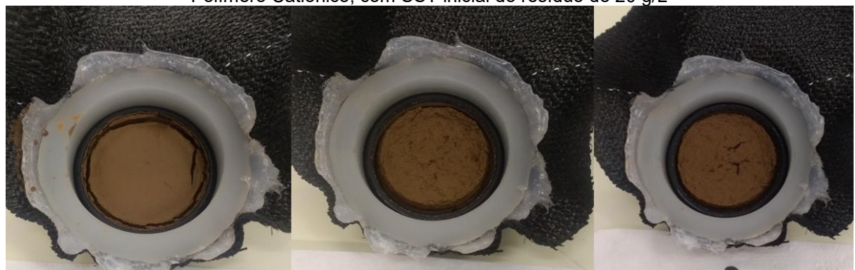
Figura 34 - Aspecto do geotêxtil ao final dos ensaios 2, 4 e 6 (esquerda para direita), utilizando Polímero Catiônico, com SST inicial do resíduo de 20 g/L
