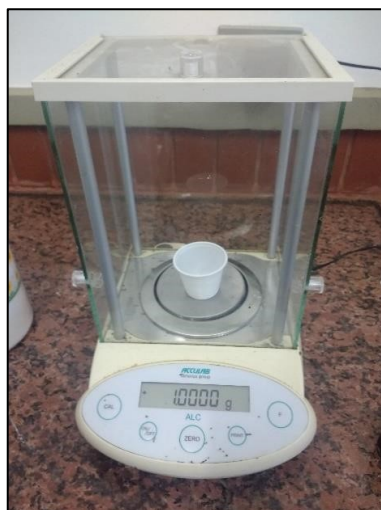
Figura 22 - Separação do polímero para preparação do condicionante químico
