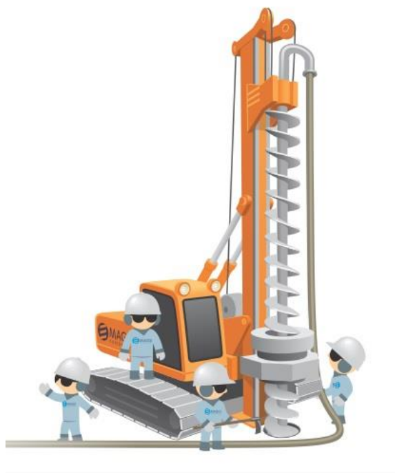
Figura 10- Estacas Hélice Contínua
