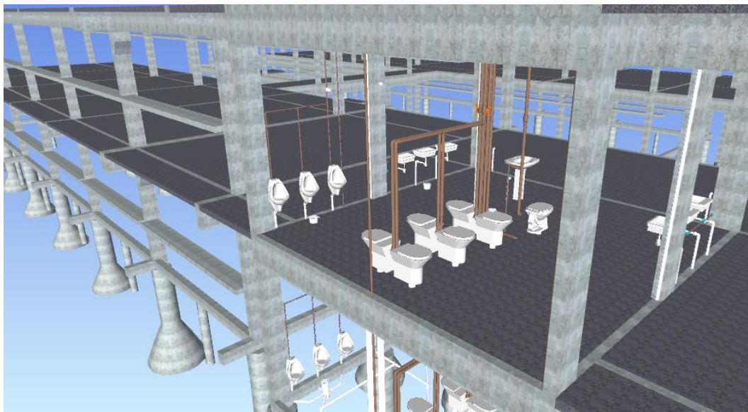
Figura 40 – Modelo integrado entre estruturas e instalações hidrossanitárias
