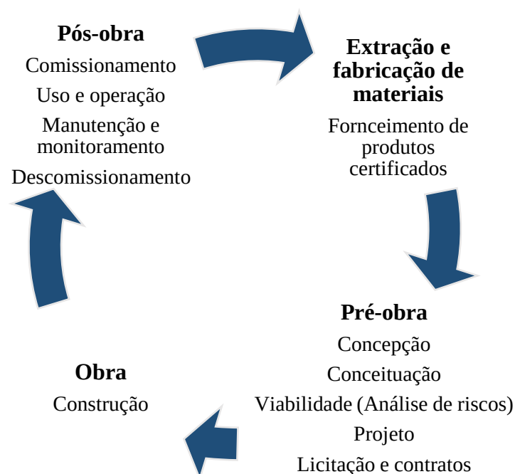
Figura 2 – Ciclo de vida de um edifício
