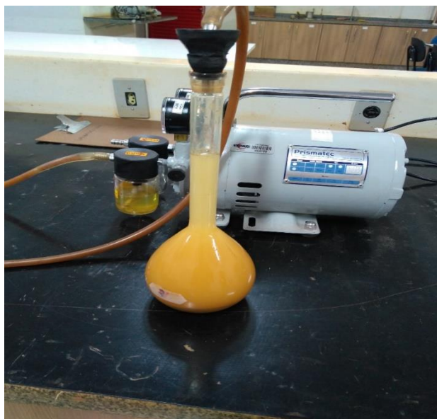
Figura 46 - Conjunto picnômetro, água destilada e solo sendo retirado o ar.
