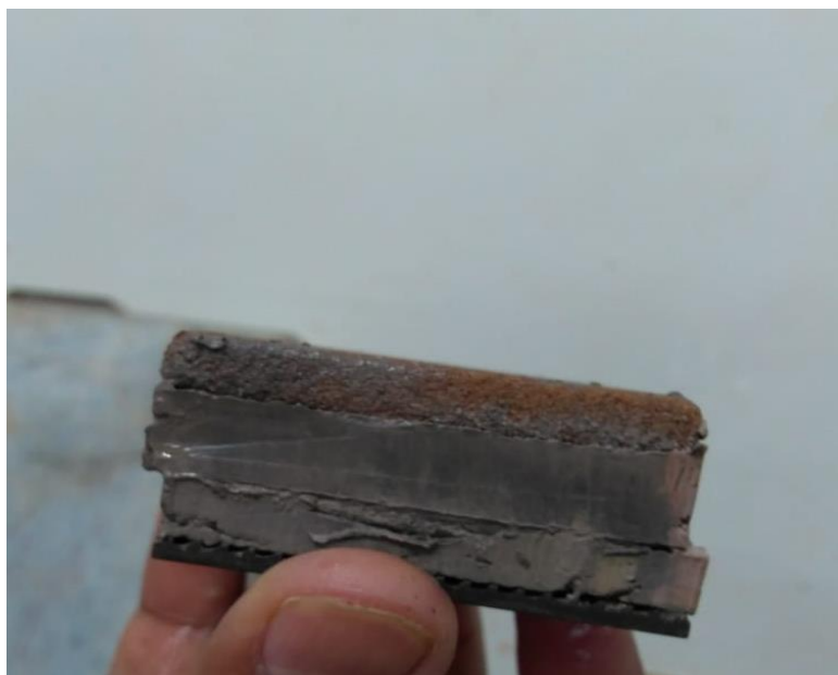
Figura 49 - Corpo de prova após o ensaio de cisalhamento direto.
