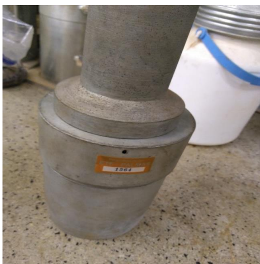
Figura 38 - Cilindro de coleta de amostras indeformadas.
