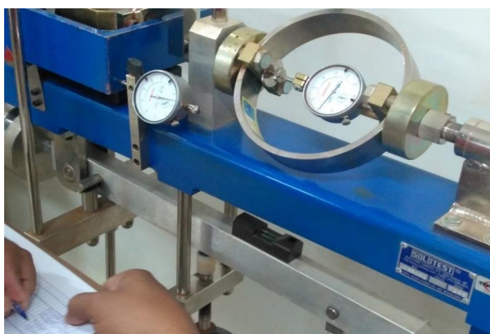
Figura 48 - Leitura do ensaio de cisalhamento direto.
