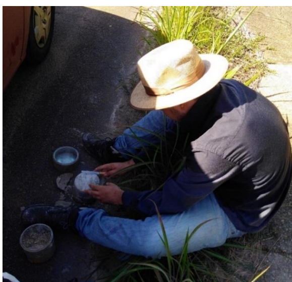
Figura 39 - Moldagem de amostra indeformada.
