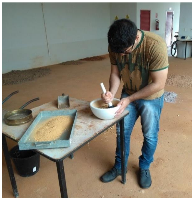
Figura 40 - Destorroamento de solo.
