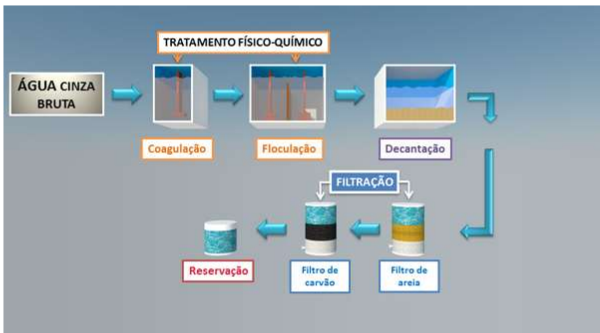
Figura 6.4: Desenho esquemático das etapas do tratamento de águas cinza.
